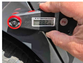
Lackstärke Seitenwand hinten rechts
