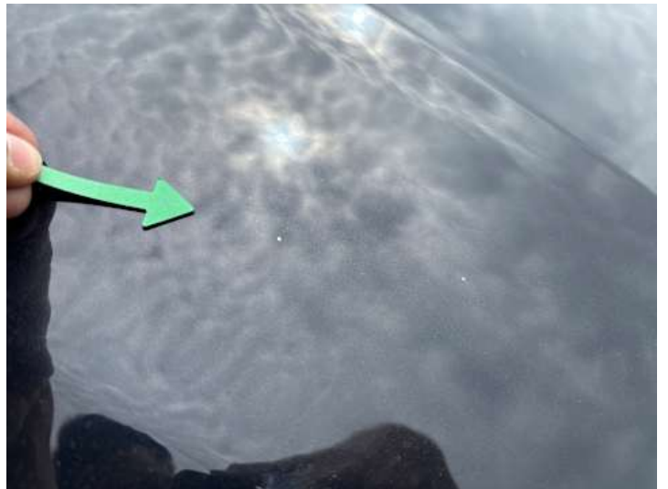
Motorhaube (Steinschlag, Kratzer)
