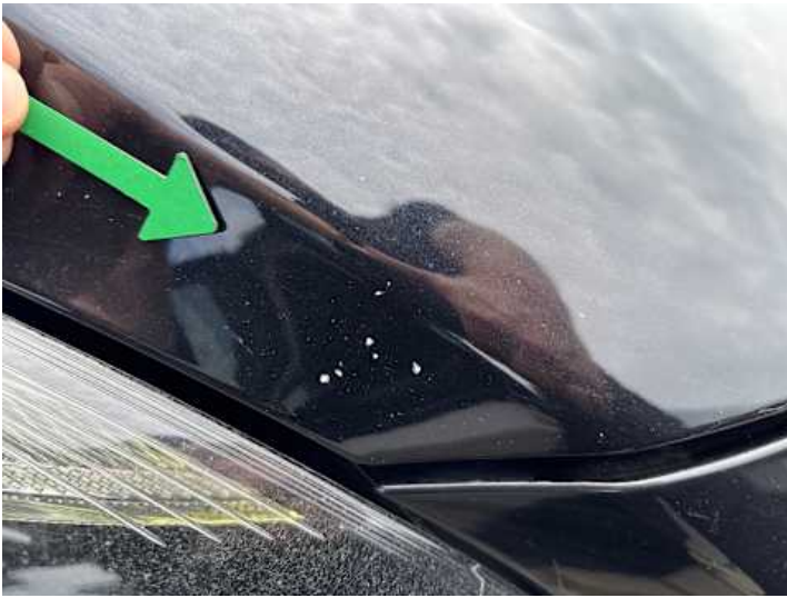
Motorhaube (Steinschlag, Kratzer)
