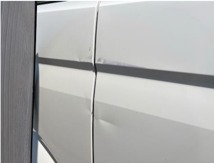
Türe hinten rechts (Verformung)
