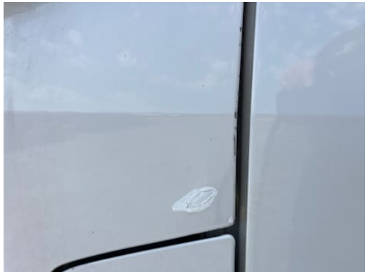
Fahrertür (Lackschaden, Unsachgemäß instand gesetzt)
