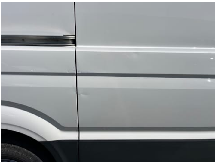
Türe hinten rechts (Verformung)
