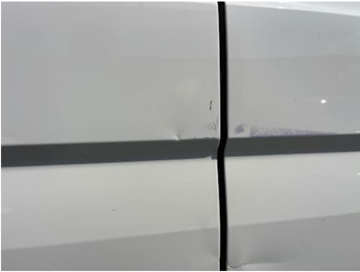
Seitenteil hinten rechts (Lackschaden, Verformung)
