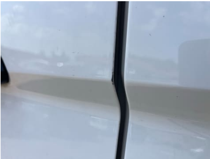
Fahrertür (Lackschaden, Unsachgemäß instand gesetzt)
