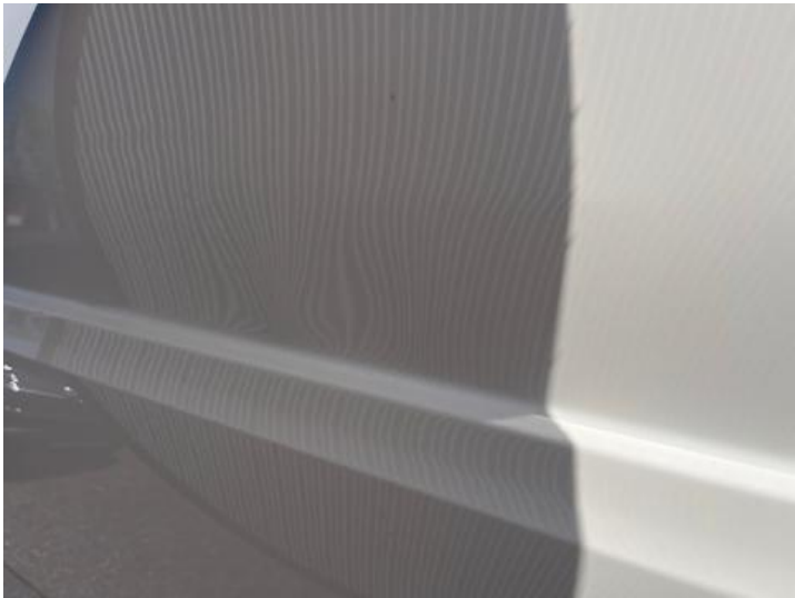
Türe hinten rechts (Verformung)
