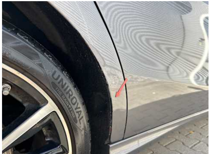
Seitenteil hinten rechts (Lackschaden, Rost)
