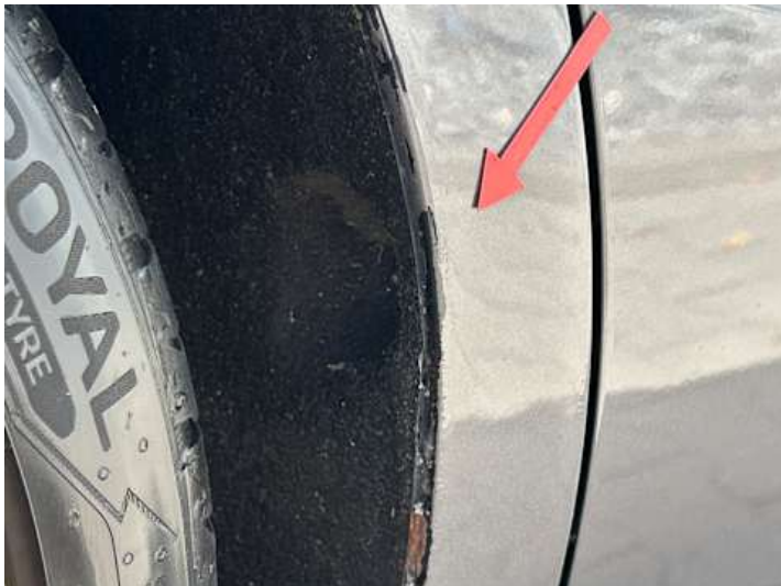
Seitenteil hinten rechts (Lackschaden, Rost)
