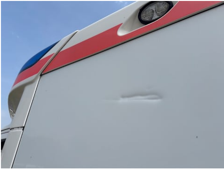
Seitenteil hinten links (Verformung)
