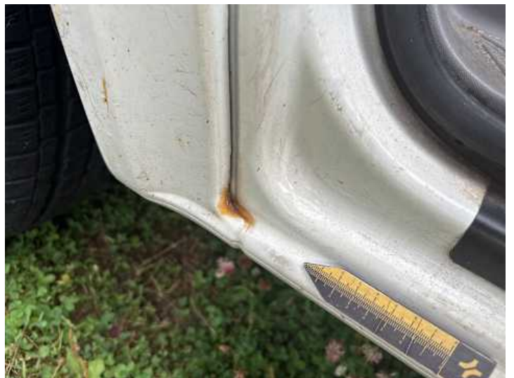
Schweller links (Rost)
