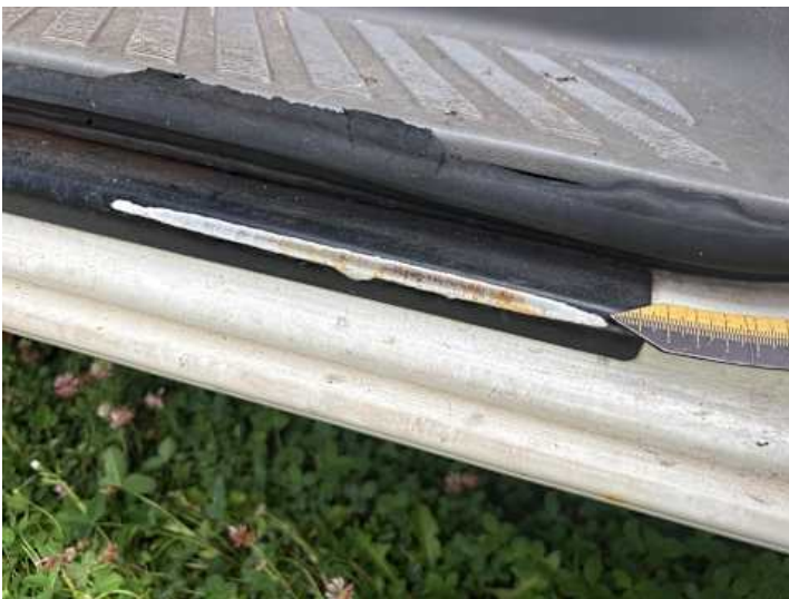
Schweller links (Rost)
