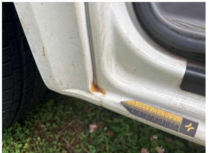
Kotflügel vorne links (Rost)
