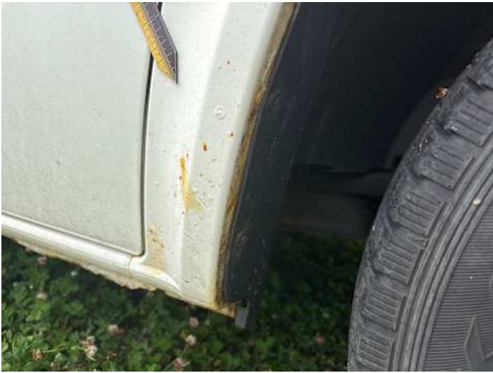
Kotflügel vorne rechts (Rost)
