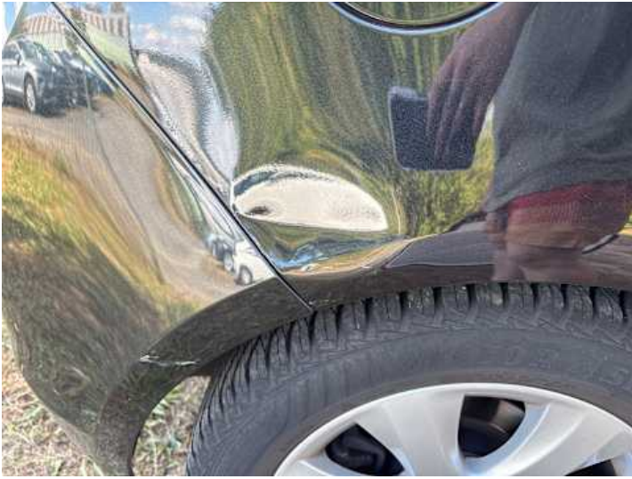
Seitenteil hinten rechts (Kratzer, Verformung)
