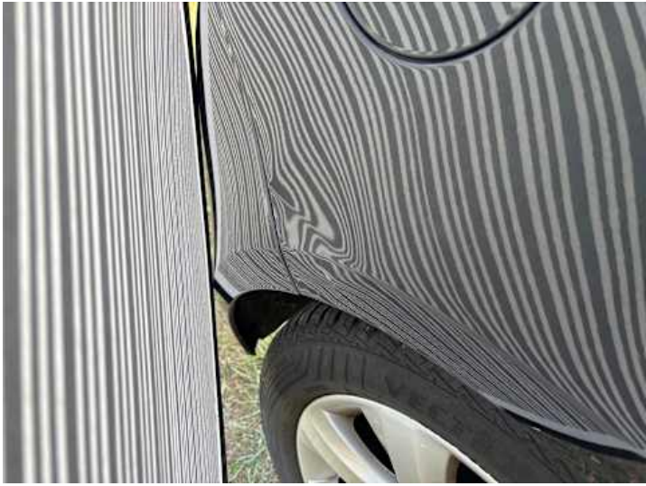
Seitenteil hinten rechts (Kratzer, Verformung)
