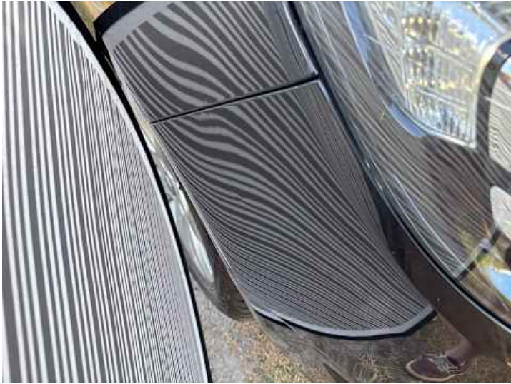
Schweller links (Verformung)
