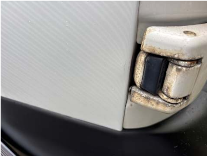
Seitenteil hinten links (Lackschaden, Verformung)
