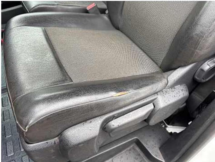
Innenraum (Riss/Bruch, Verschleiß)
