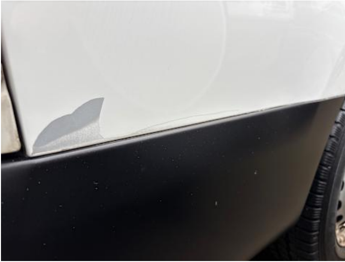
Seitenteil hinten rechts (Lackschaden)
