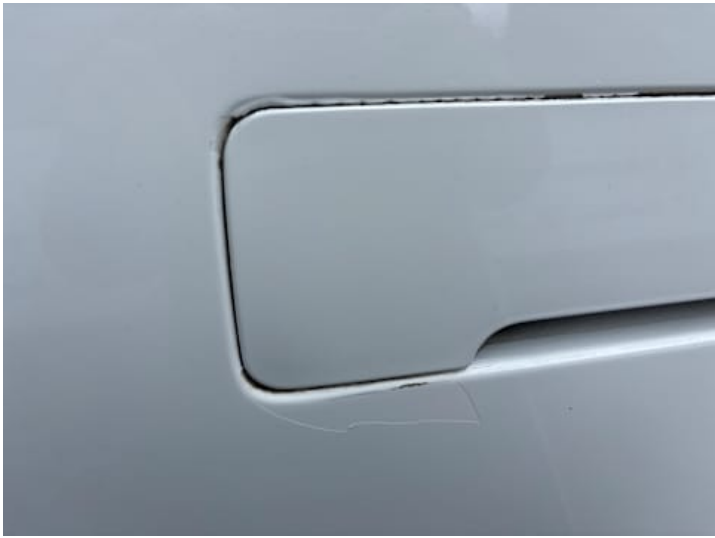
Seitenteil hinten rechts (Lackschaden)
