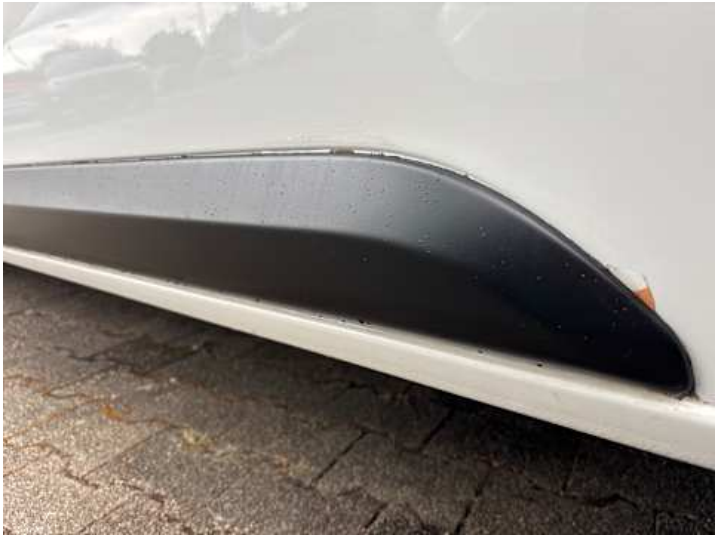
Seitenteil hinten links (Unsachgemäß instand gesetzt)
