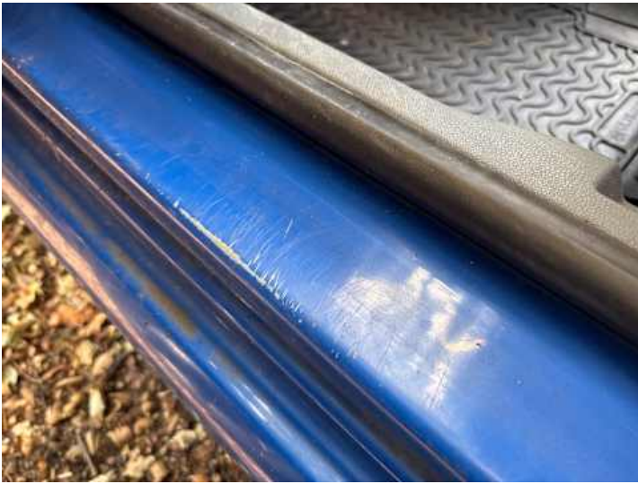
Schweller links (Kratzer, Rost)
