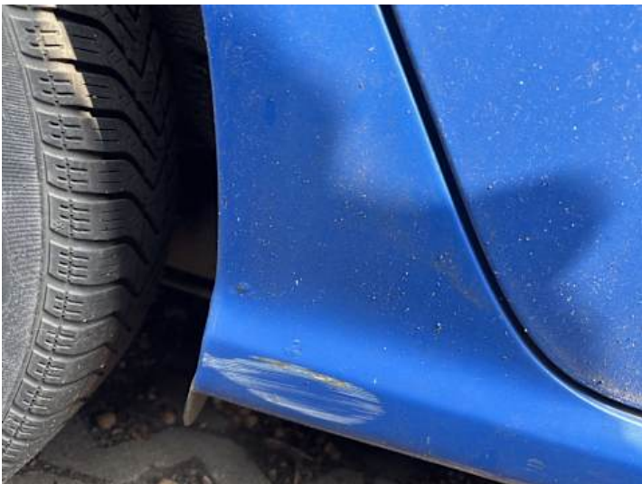
Seitenteil hinten rechts (Kratzer, Rost)
