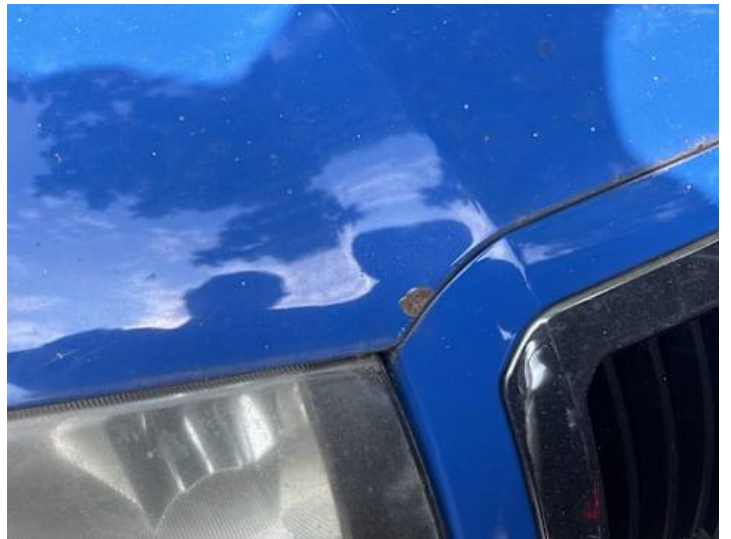
Motorhaube (Rost, Lackschaden)
