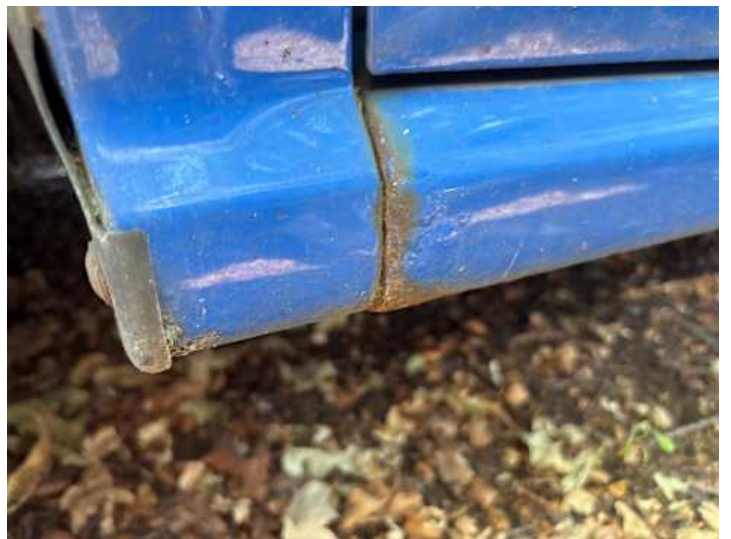
Schweller links (Kratzer, Rost)
