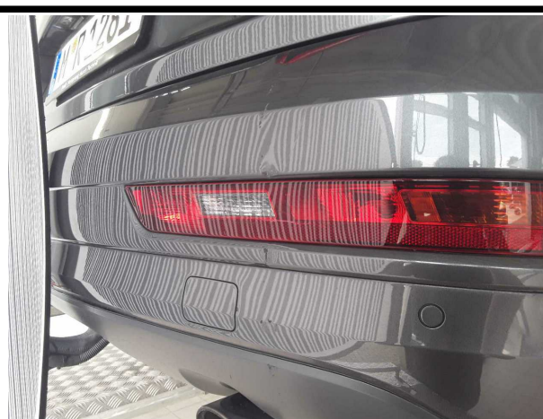
Beschädigung #4: Stossfänger hinten: Stossfänger hinten (Plastisch verformt) - beschädigt - erneuern
