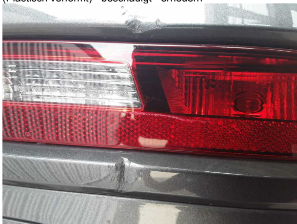
Beschädigung #4: Stossfänger hinten: Stossfänger hinten (Plastisch verformt) - beschädigt - erneuern
