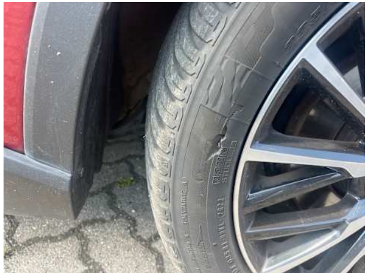
Rad (Anderer Schaden): Flanke beschädigt
