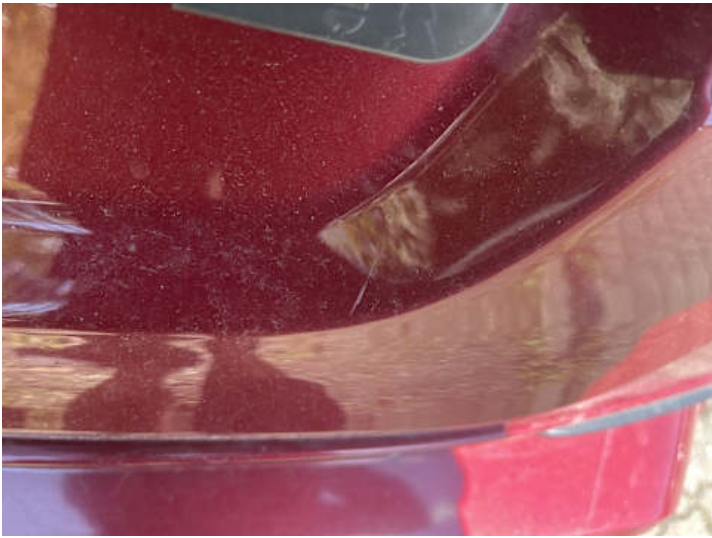
Heckklappe (Kratzer, Lackschaden)
