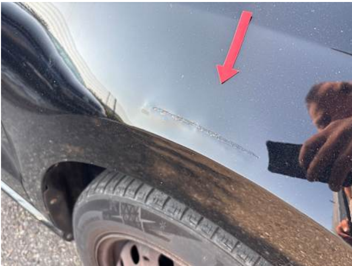
Kotflügel vorne rechts (Kratzer, Lackschaden, Rost, Verformung)
