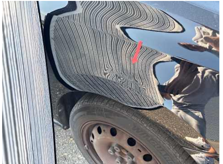
Kotflügel vorne rechts (Kratzer, Lackschaden, Rost, Verformung)
