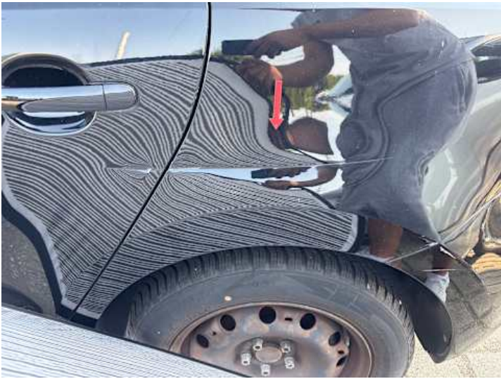
Seitenteil hinten links (Verformung, Lackschaden)
