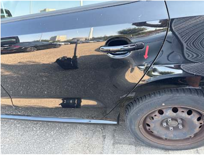
Türe hinten links (Lackschaden, Verformung)
