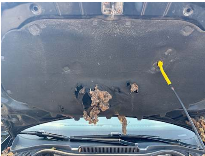
Motorhaube (Anderer Schaden): Marderspuren
