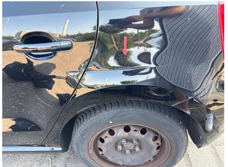
Seitenteil hinten links (Verformung, Lackschaden)
