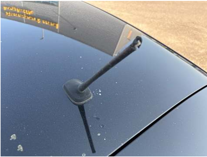
Dach (Anderer Schaden): Marderspuren
