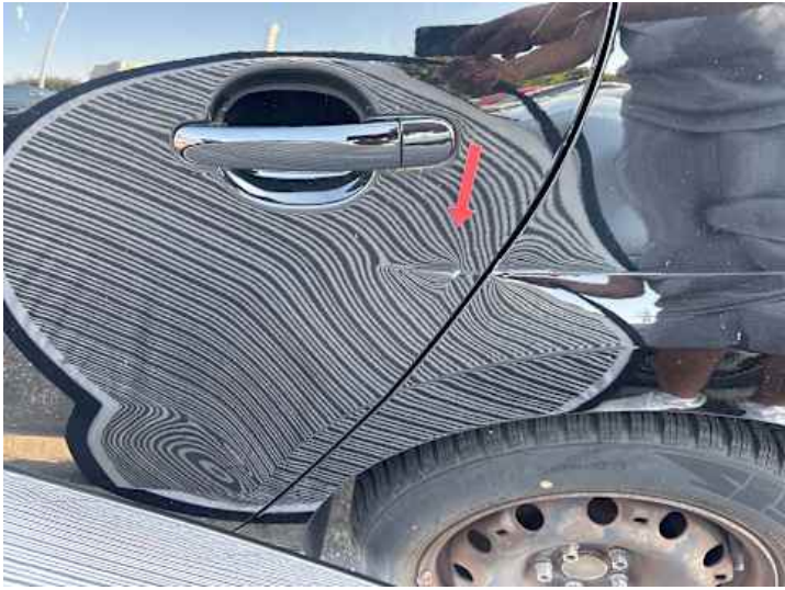
Türe hinten links (Lackschaden, Verformung)
