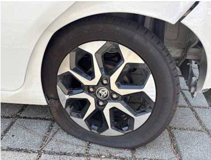
Rad (Ohne Luft, Riss/Bruch, Verformung)
