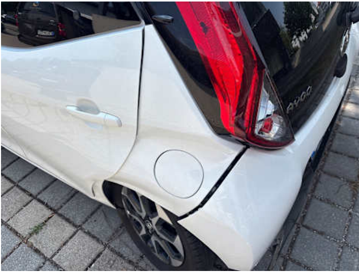
Seitenteil hinten links (Kratzer, Delle, Lackschaden, Riss/Bruch, Spaltmaße ungenau, Verformung)
