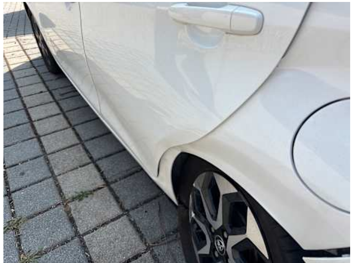
Türe hinten links (Verformung, Kratzer, Lackschaden, Delle, Spaltmaße ungenau)
