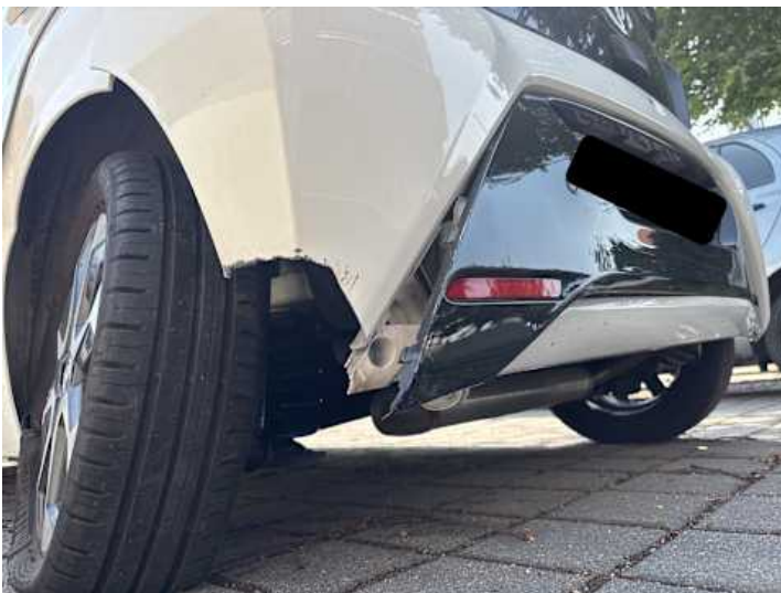
Stoßstange hinten (Delle, Kratzer, Lackschaden, Riss/Bruch, Spaltmaße ungenau, Verformung)
