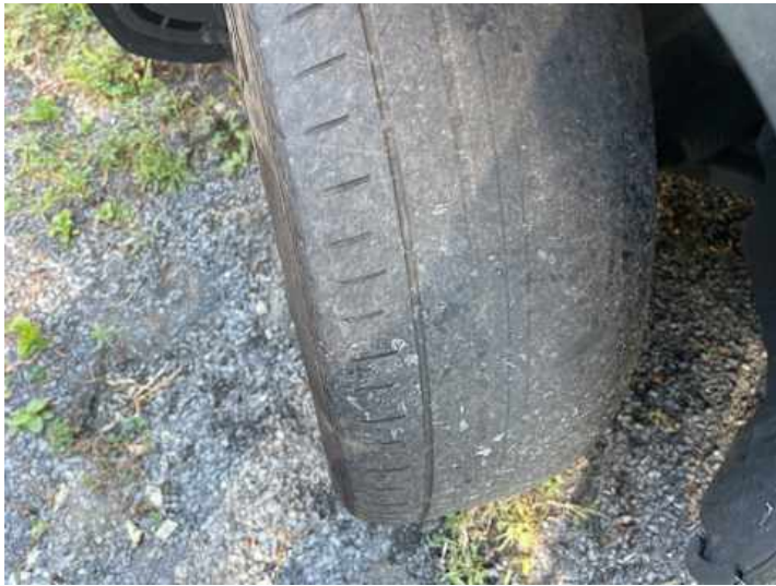
Rad (Ungleichmäßig abgefahren)
