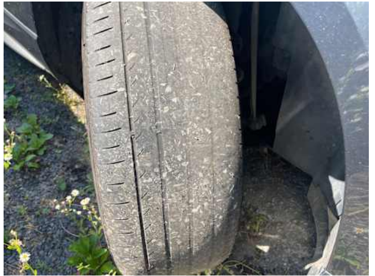
Rad (Ungleichmäßig abgefahren)
