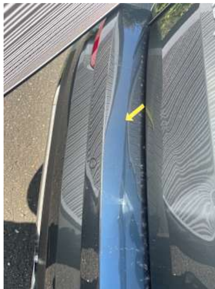
Stoßstange hinten (Verformung)
