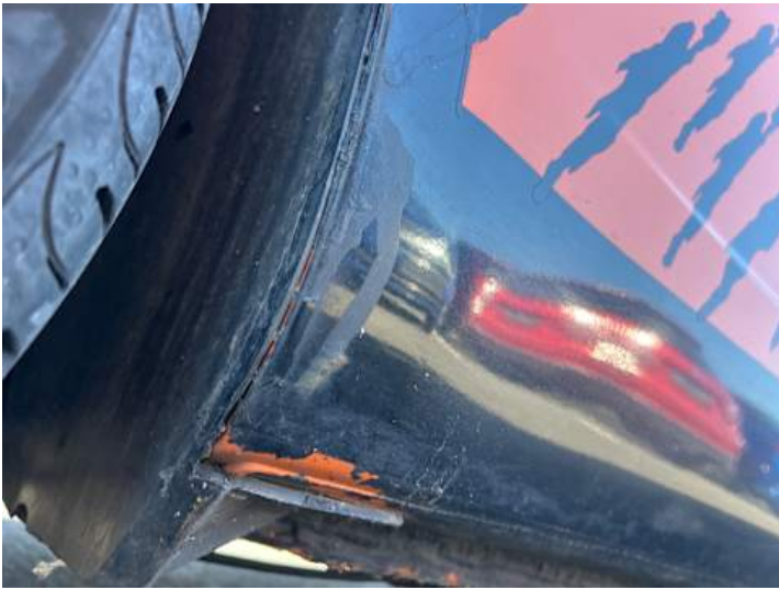
Schweller rechts (Rost)
