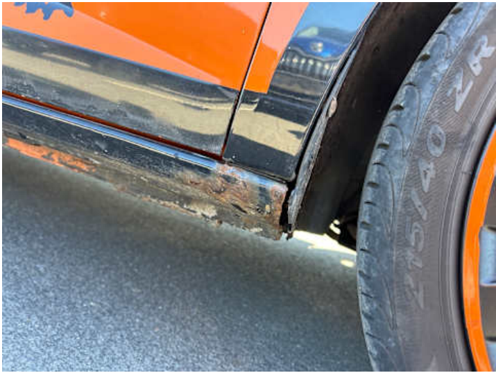
Schweller rechts (Rost)
