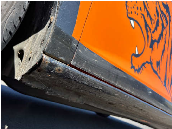
Schweller links (Rost)
