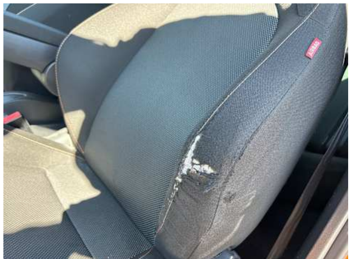
Innenraum (Verschleiß, Diverse Schäden)
