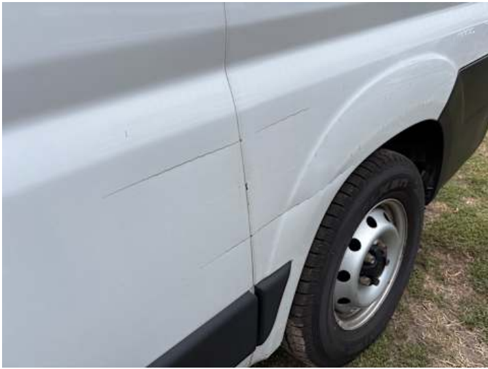
Seitenteil hinten links (Kratzer, Verformung)
