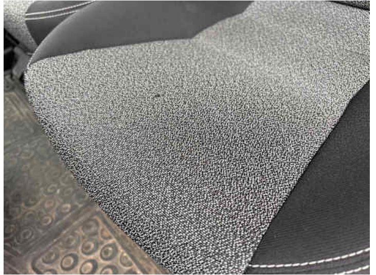
Innenraum (Verschleiß, Brandloch)
