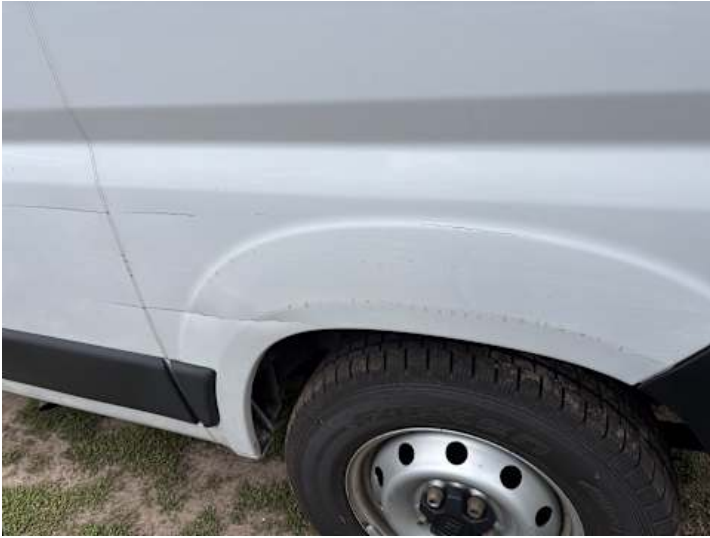
Seitenteil hinten links (Kratzer, Verformung)
