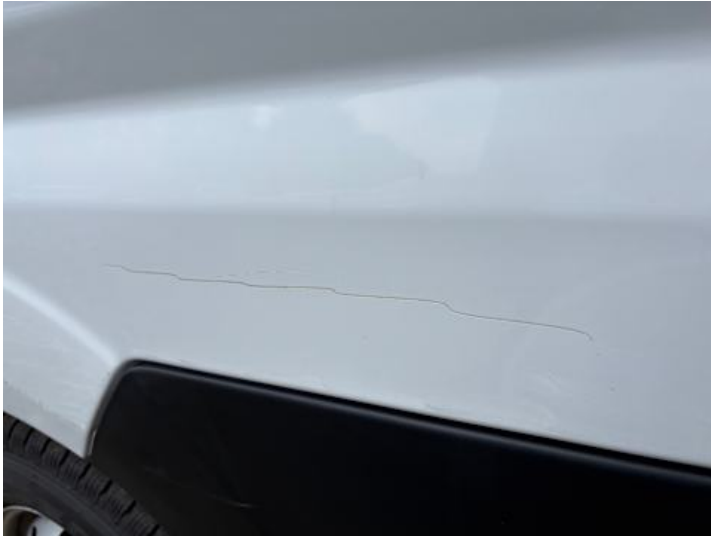
Seitenteil hinten links (Kratzer, Verformung)
