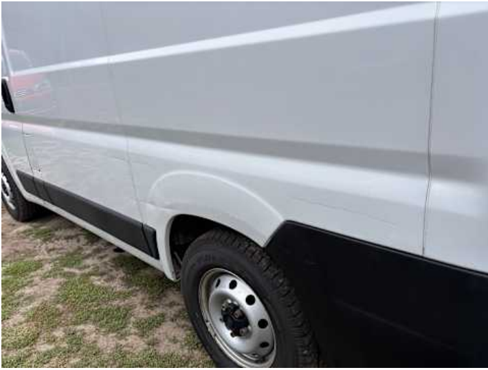
Seitenteil hinten links (Kratzer, Verformung)
