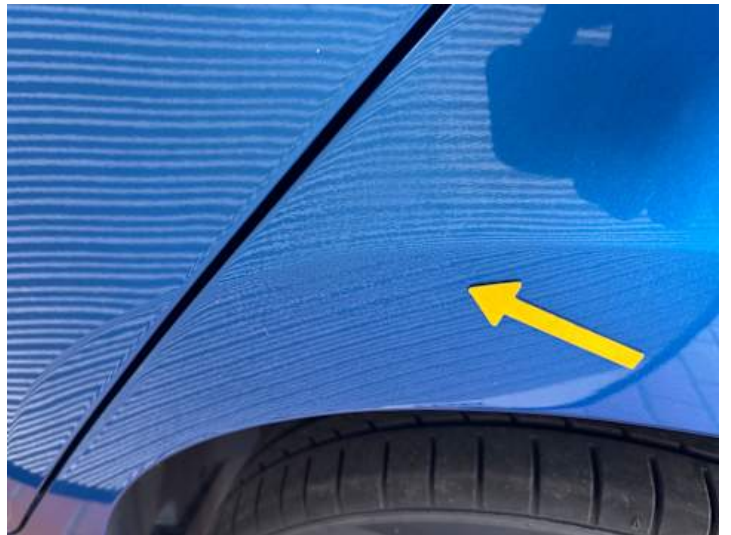
Seitenteil hinten links (Unsachgemäß instand gesetzt)
