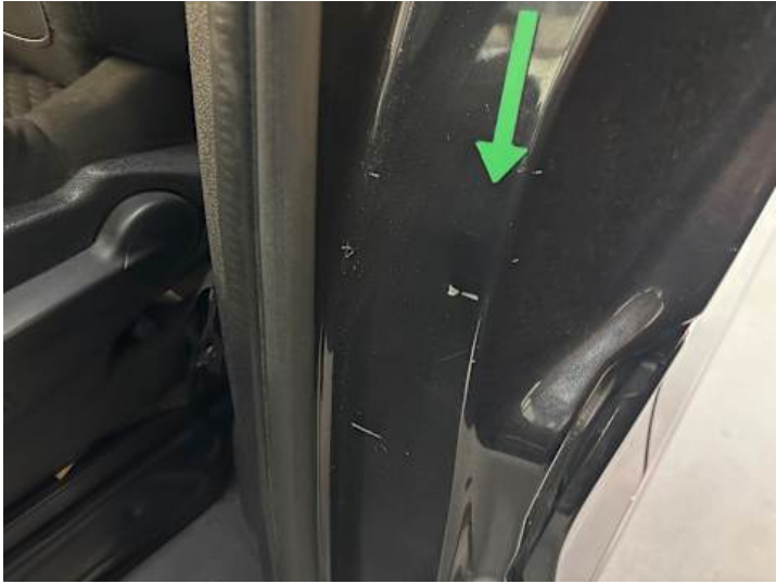
Schweller links (Kratzer, Delle)
