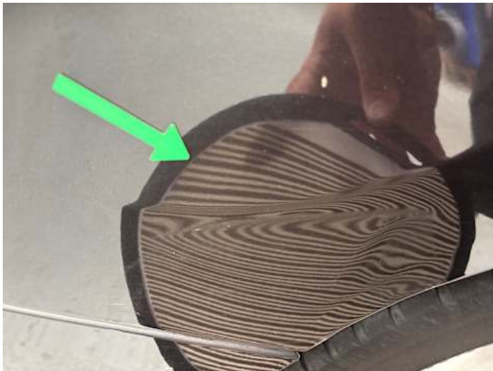
Seitenteil hinten rechts (Verformung)
