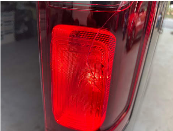
Rücklicht (rechts) (Riss/Bruch)
