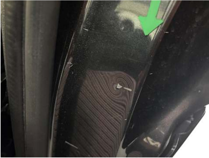
Schweller links (Kratzer, Delle)
