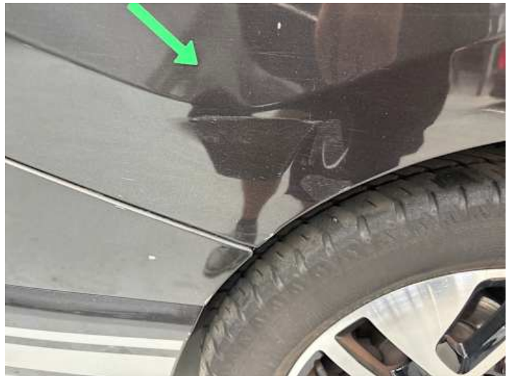
Seitenteil hinten rechts (Verformung)
