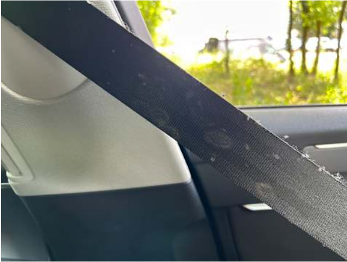
Innenraum (Anderer Schaden): Schimmel
