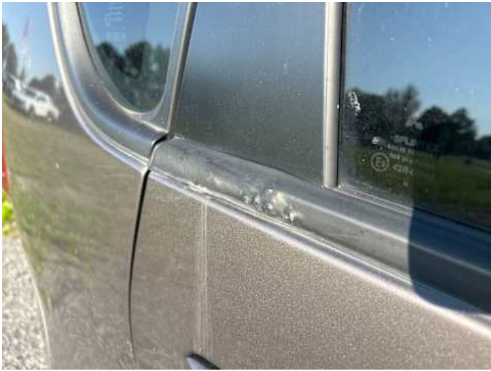
Türe hinten rechts (Rost)
