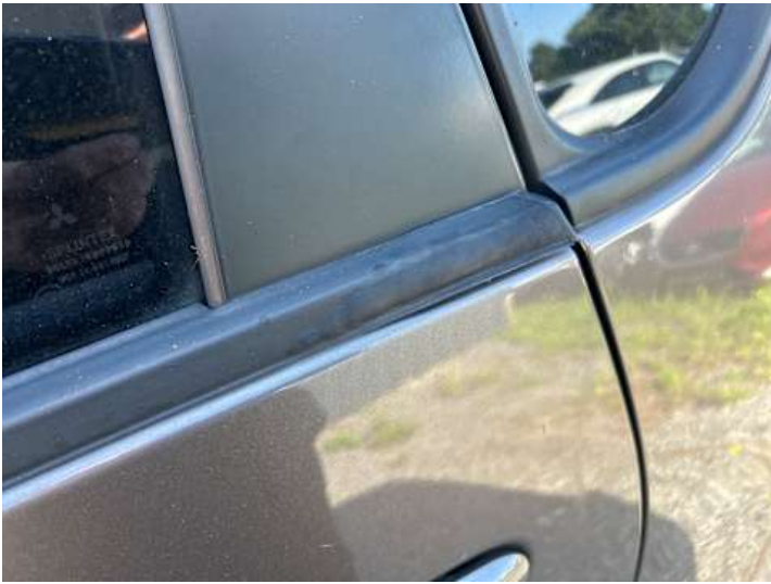
Türe hinten links (Rost)
