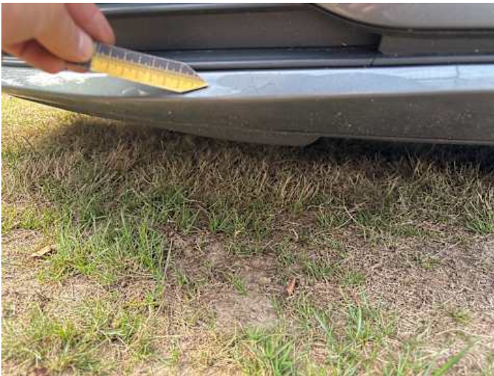
Stoßstange vorne (Lackschaden, Riss/Bruch)
