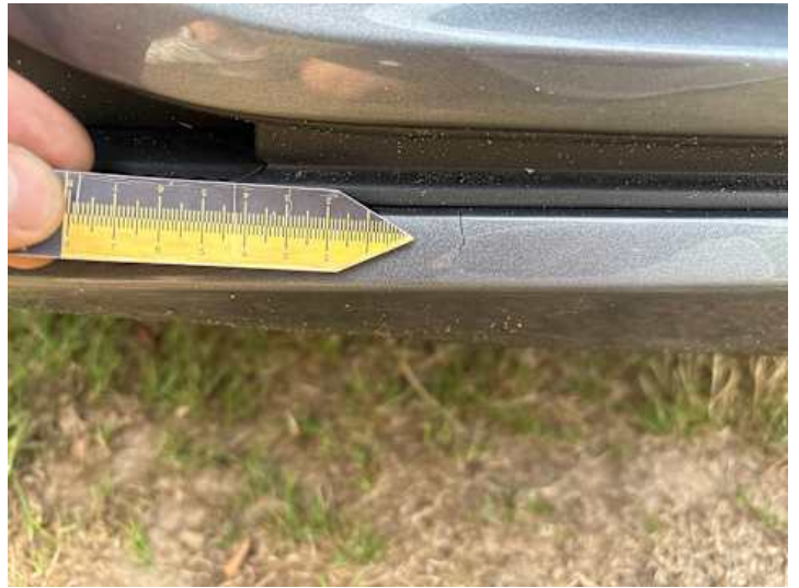
Stoßstange vorne (Lackschaden, Riss/Bruch)
