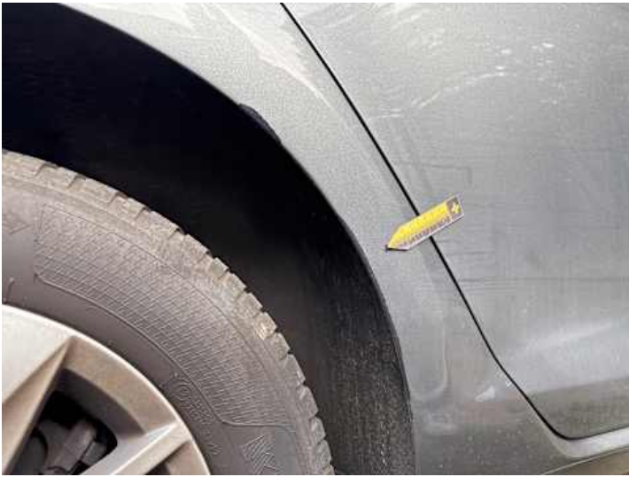
Seitenteil hinten rechts (Lackschaden, Unsachgemäß instand gesetzt)
