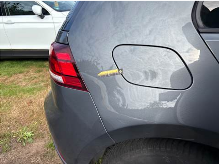
Seitenteil hinten rechts (Lackschaden)
