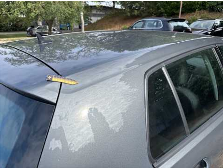
Dach (Unsachgemäß instand gesetzt)
