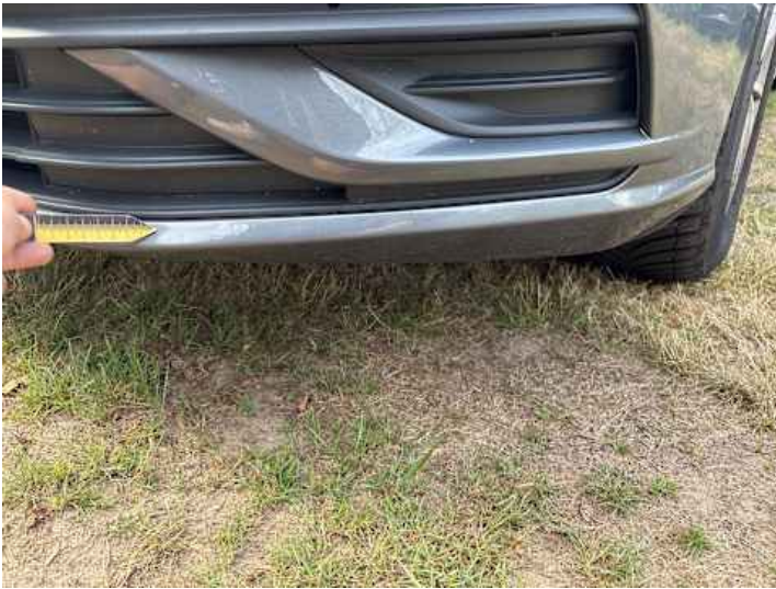
Stoßstange vorne (Lackschaden, Riss/Bruch)
