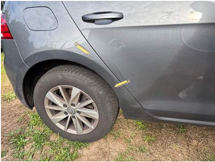
Seitenteil hinten rechts (Lackschaden, Unsachgemäß instand gesetzt)
