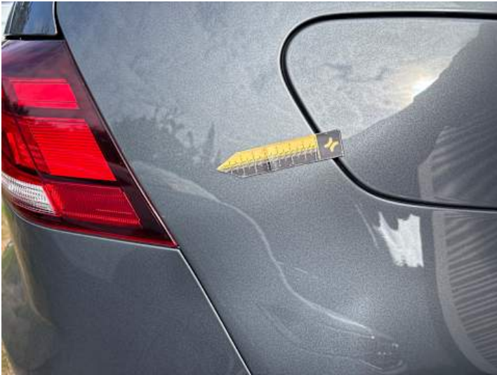
Seitenteil hinten rechts (Lackschaden)
