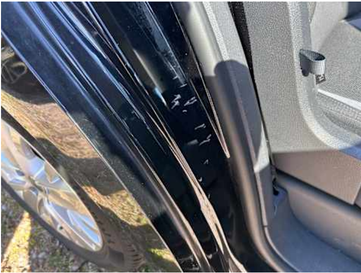
Schweller rechts (Kratzer, Delle)
