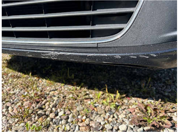
Stoßstange vorne (Lackschaden, Kratzer)
