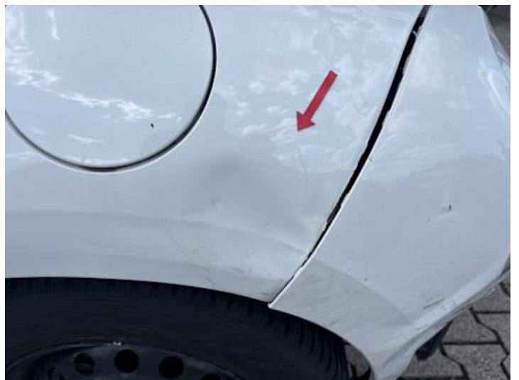
Seitenteil hinten links (Delle, Lackschaden)
