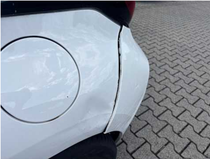
Stoßstange hinten (Spaltmaße ungenau, Riss/Bruch, Lackschaden)
