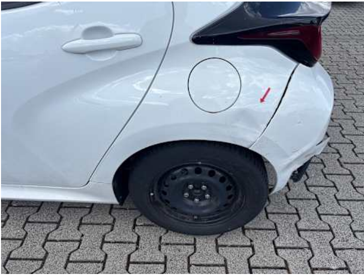
Seitenteil hinten links (Delle, Lackschaden)
