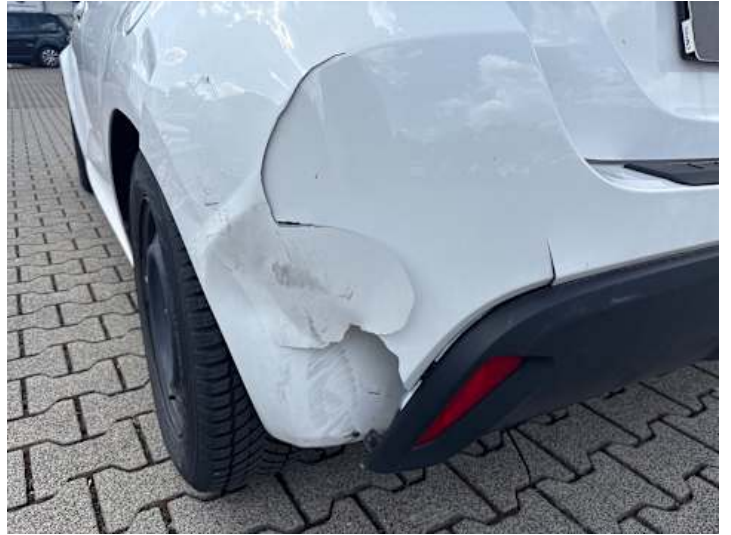
Stoßstange hinten (Spaltmaße ungenau, Riss/Bruch, Lackschaden)
