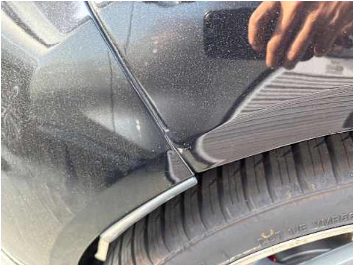
Seitenteil hinten rechts (Lackschaden, Kratzer)
