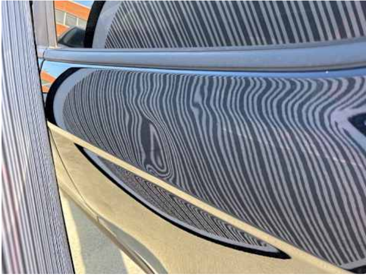
Seitenteil hinten links (Verformung, Kratzer)
