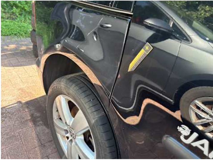
Türe hinten rechts (Lackschaden)
