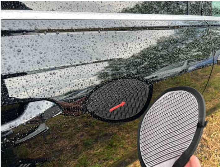
Türe hinten rechts (Delle)
