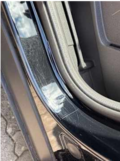
Schweller links (Kratzer)
