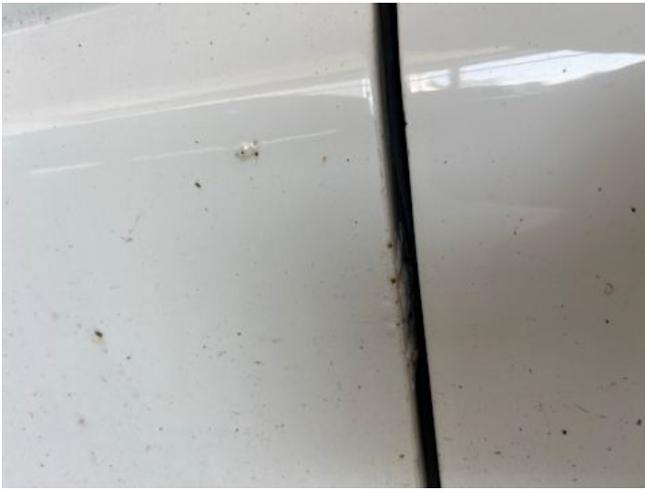
Türe hinten rechts (Lackschaden, Rost)
