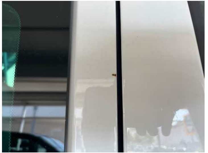
Türe hinten rechts (Lackschaden, Rost)
