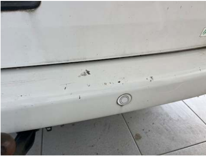
Stoßstange hinten (Kratzer, Lackschaden, Riss/Bruch, Verformung)
