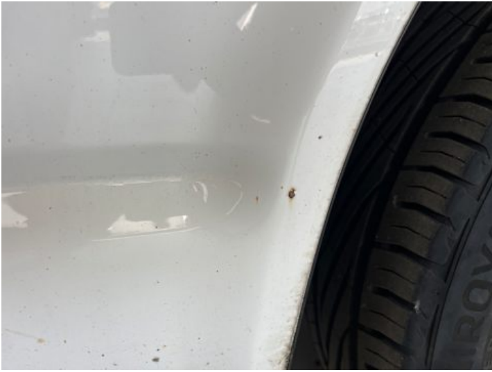
Beifahrtür (Lackschaden, Rost)
