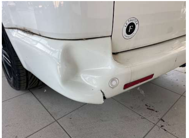
Stoßstange hinten (Kratzer, Lackschaden, Riss/Bruch, Verformung)
