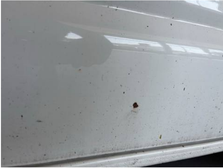
Beifahrtür (Lackschaden, Rost)
