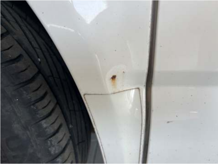
Seitenteil hinten rechts (Lackschaden, Rost)
