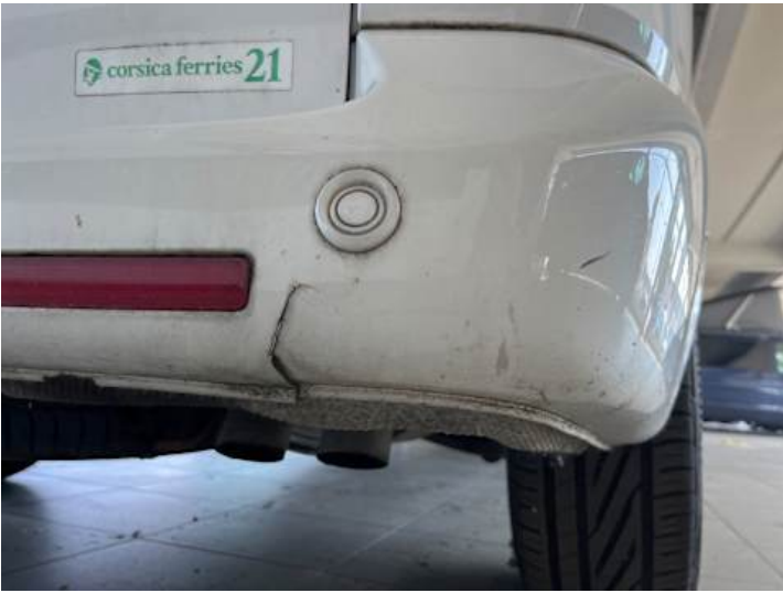
Stoßstange hinten (Kratzer, Lackschaden, Riss/Bruch, Verformung)
