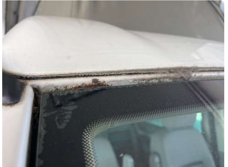
Dach (Lackschaden, Rost)
