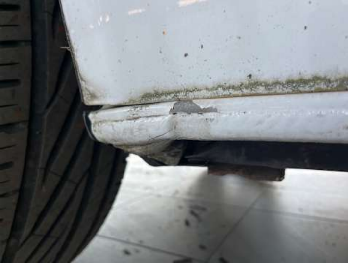
Schweller links (Lackschaden, Verformung)
