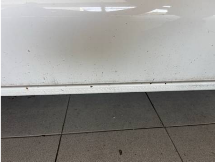
Schweller rechts (Lackschaden, Rost)
