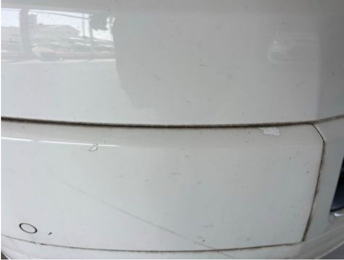
Schweller links (Lackschaden, Verformung)
