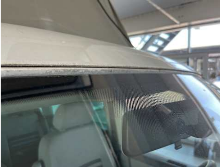
Dach (Lackschaden, Rost)
