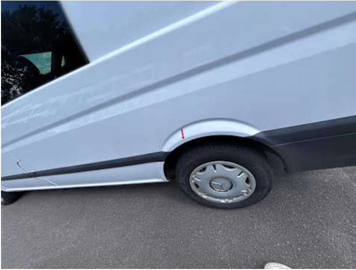
Seitenteil hinten links (Rost)
