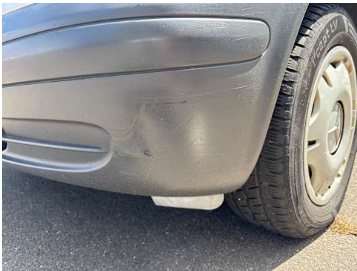
Stoßstange vorne (Delle, Kratzer)
