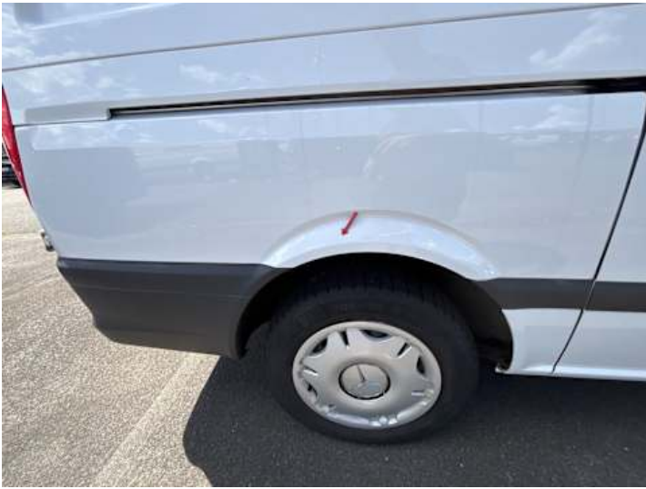
Seitenteil hinten rechts (Rost)
