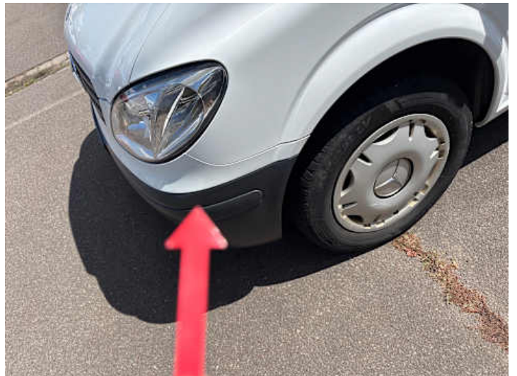
Stoßstange vorne (Kratzer, Spaltmaße ungenau)
