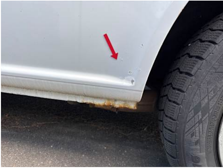
Seitenteil hinten links (Rost)
