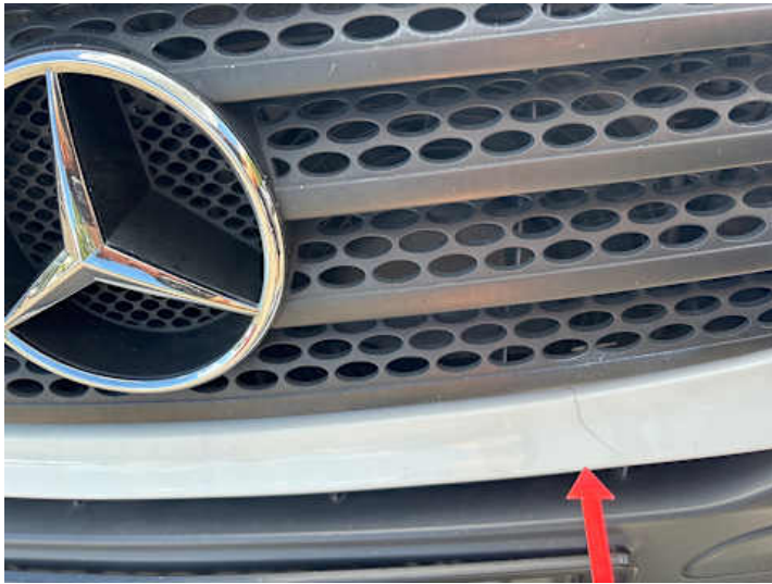
Stoßstange vorne (Riss/Bruch)
