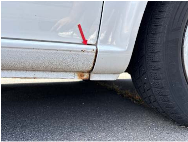
Schweller rechts (Rost)
