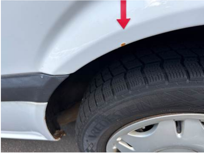
Seitenteil hinten links (Rost)
