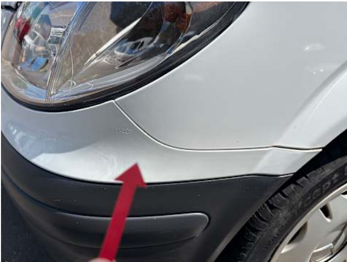
Stoßstange vorne (Kratzer, Spaltmaße ungenau)
