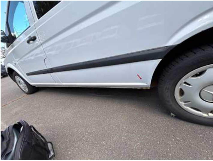
Seitenteil hinten links (Rost)
