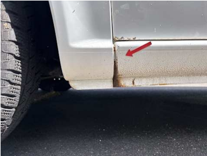
Schweller links (Rost)
