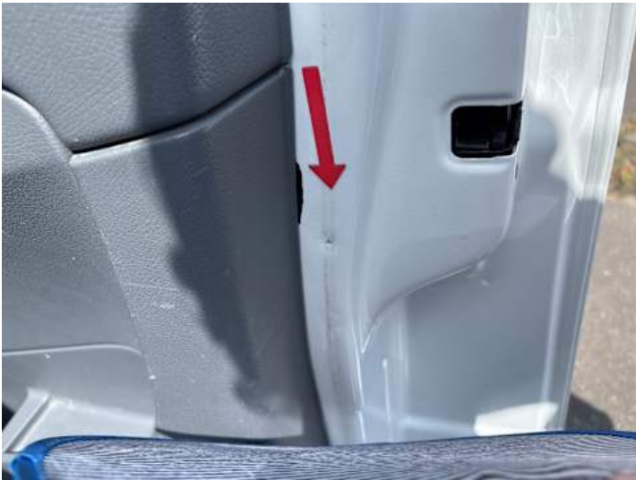
Beifahrertür (Kratzer, Delle)
