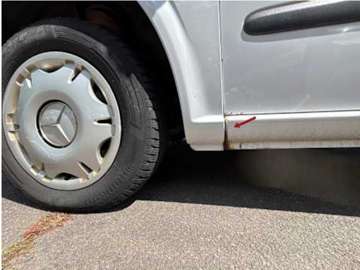
Schweller links (Rost)
