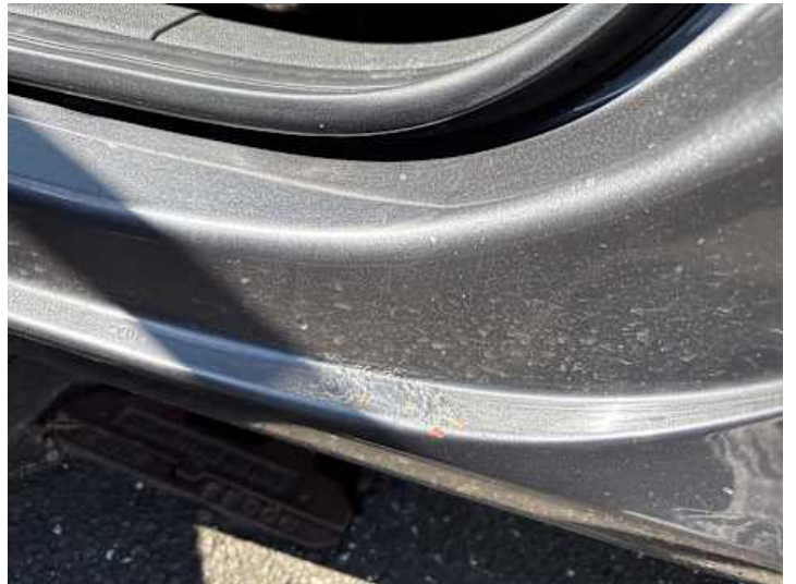
Schweller links (Rost)
