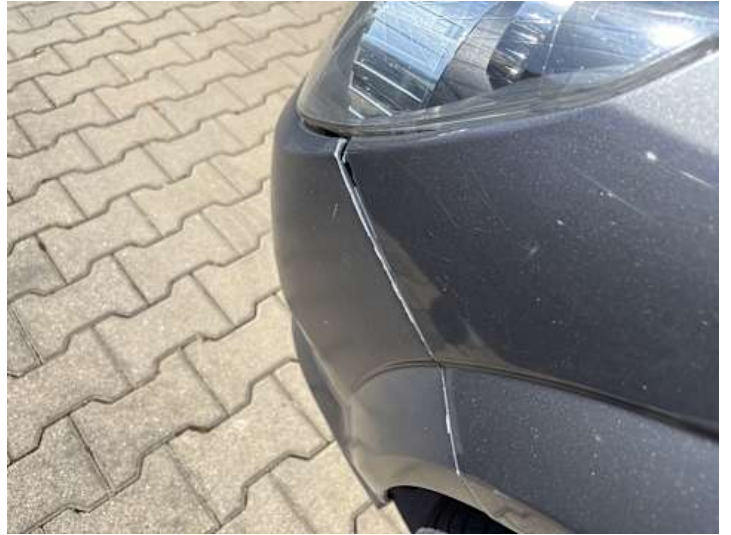
Stoßstange vorne (Spaltmaße ungenau)
