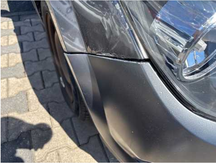
Stoßstange vorne (Spaltmaße ungenau)
