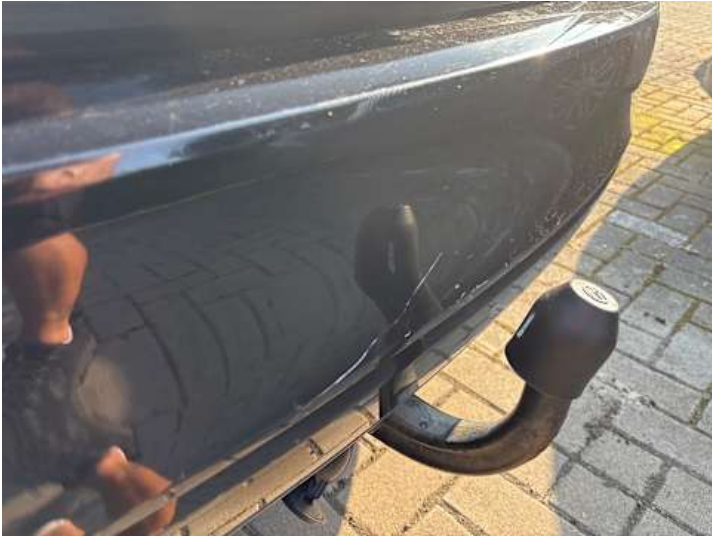
Stoßstange hinten (Kratzer, Lackschaden, Verformung)
