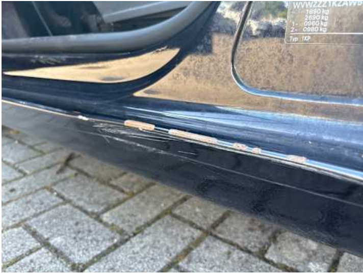
Schweller links (Verformung, Rost, Kratzer)
