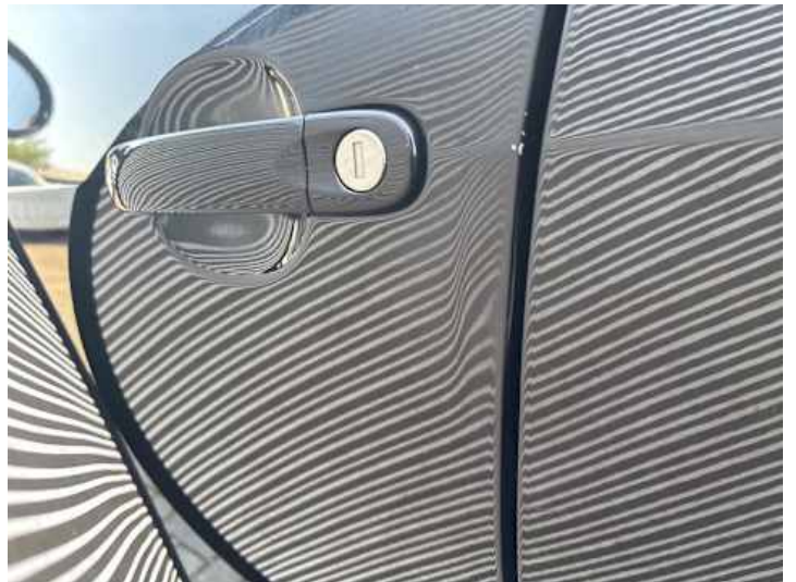
Fahrtür (Kratzer, Verformung)
