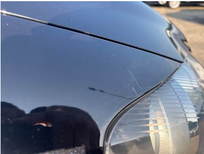
Kotflügel vorne rechts (Kratzer, Rost)
