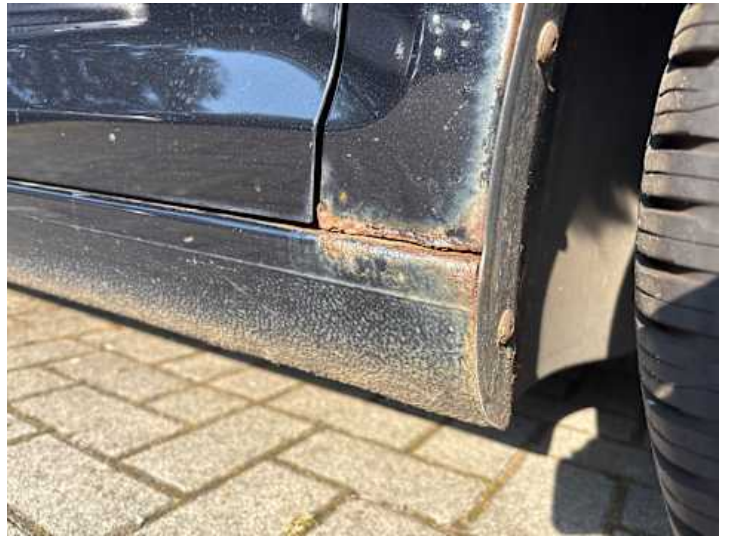
Schweller rechts (Rost, Verformung)
