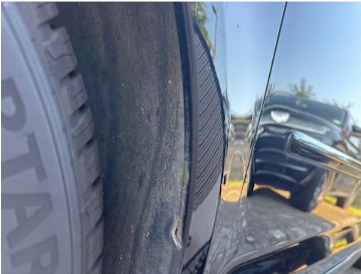
Kotflügel vorne links (Rost)
