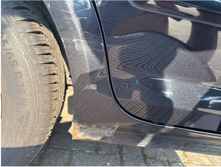
Seitenteil hinten rechts (Verformung, Kratzer)
