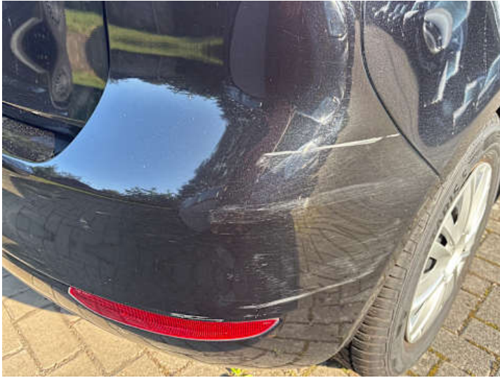
Stoßstange hinten (Kratzer, Lackschaden, Verformung)
