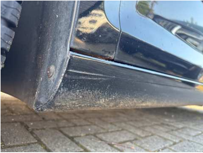
Schweller links (Verformung, Rost, Kratzer)
