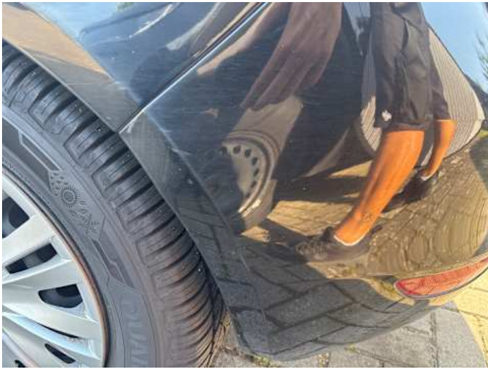
Stoßstange hinten (Kratzer, Lackschaden, Verformung)
