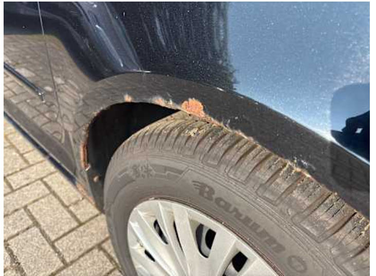
Kotflügel vorne rechts (Kratzer, Rost)
