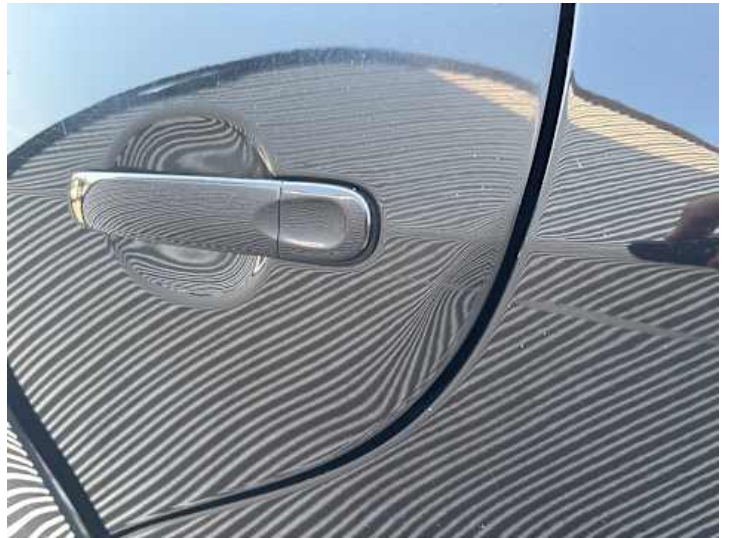
Türe hinten links (Verformung)
