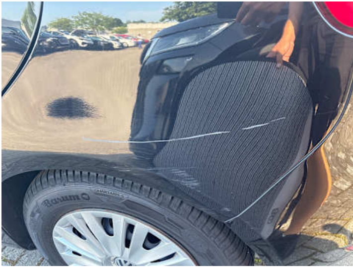
Seitenteil hinten links (Kratzer, Verformung, Delle)
