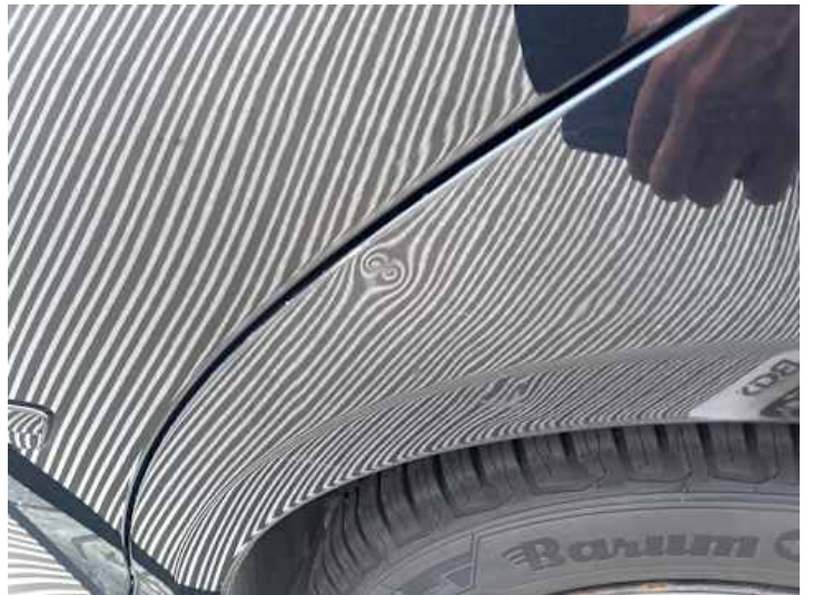
Seitenteil hinten links (Kratzer, Verformung, Delle)
