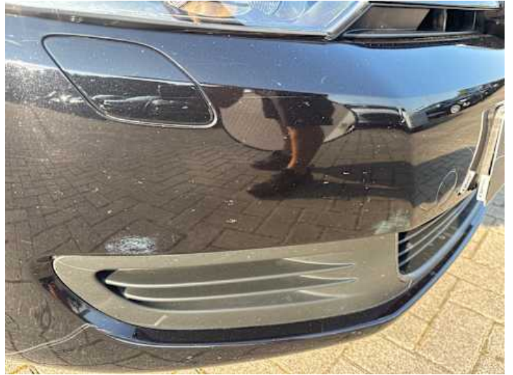
Stoßstange vorne (Kratzer, Verformung)
