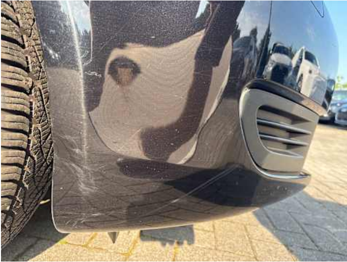
Stoßstange vorne (Kratzer, Verformung)
