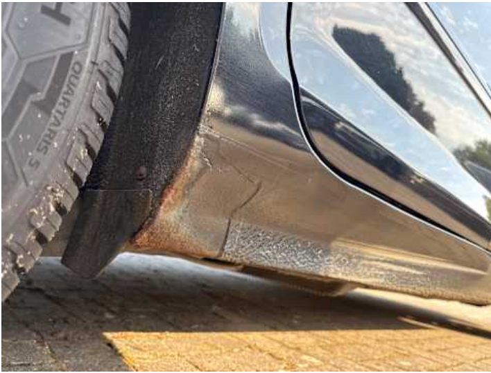
Schweller rechts (Rost, Verformung)
