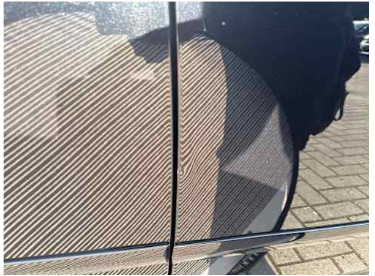
Beifahrtür (Kratzer, Delle)
