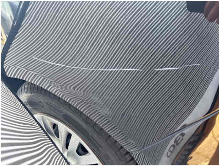
Seitenteil hinten links (Kratzer, Verformung, Delle)
