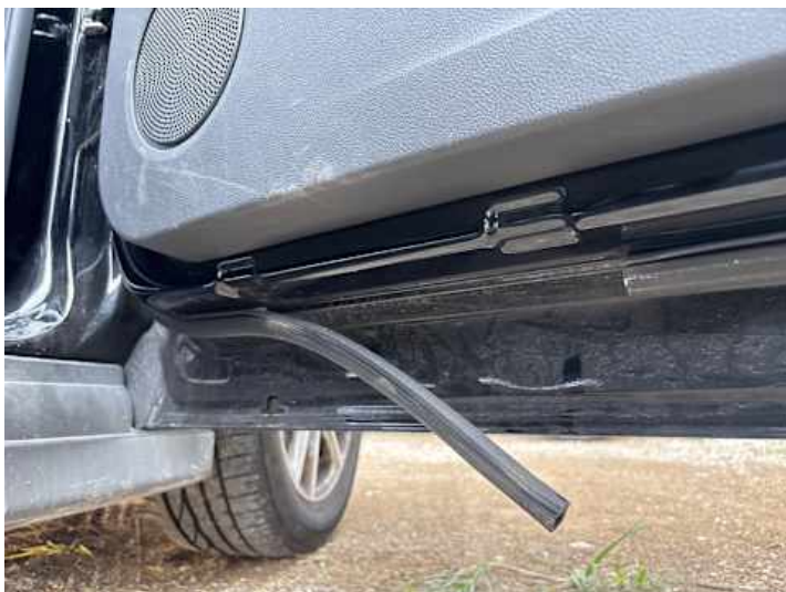
Beifahrtür (Anderer Schaden): Dichtung gerissen
