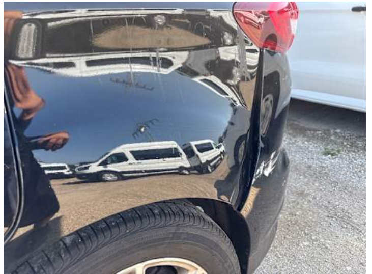
Seitenteil hinten links (Verformung, Lackschaden)
