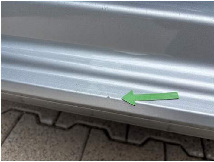
Schweller links (Lackschaden)
