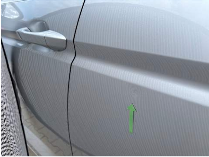
Türe hinten links (Lackschaden, Delle)
