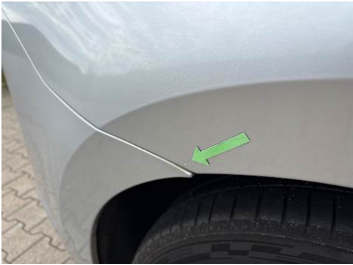
Seitenteil hinten rechts (Spaltmaße ungenau)
