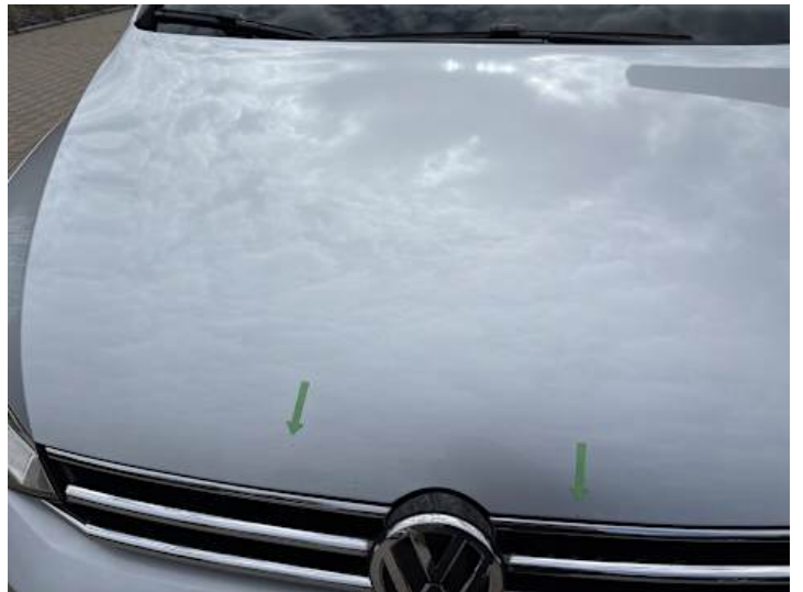
Motorhaube (Steinschlag, Lackschaden)
