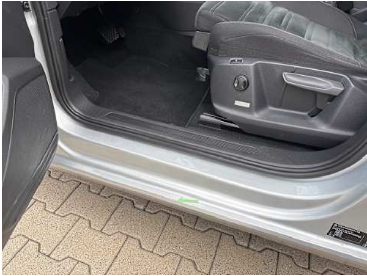
Schweller links (Lackschaden)
