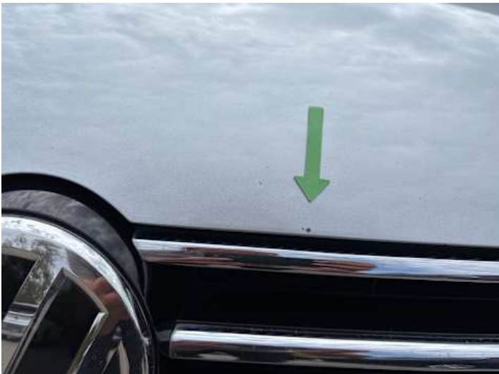
Motorhaube (Steinschlag, Lackschaden)
