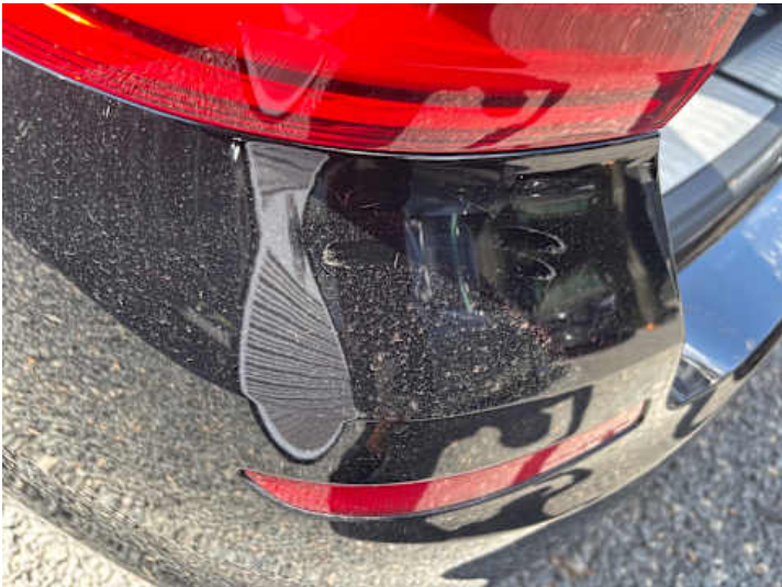
Stoßstange hinten (Kratzer)
