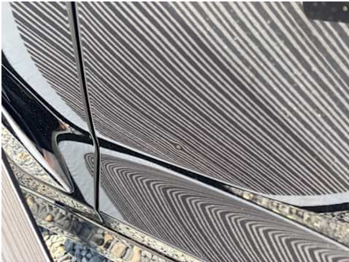
Fahrtür (Delle, Kratzer)
