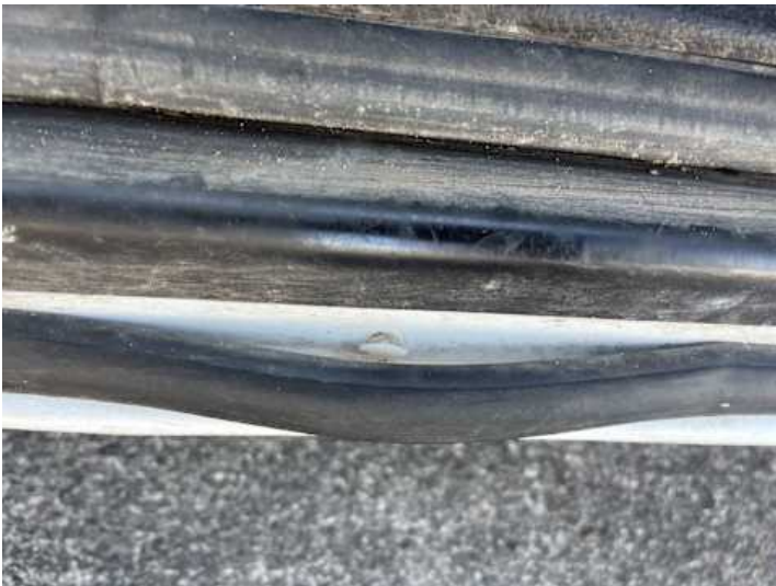
Fahrertür (Anderer Schaden): Tüрдichtung beschädigt
