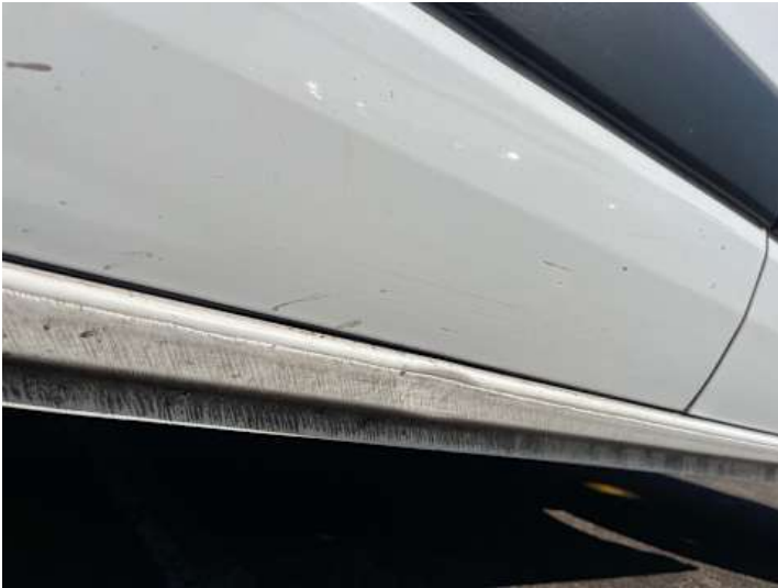
Schweller rechts (Verformung)
