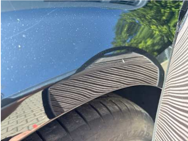
Kotflügel vorne links (Verformung)
