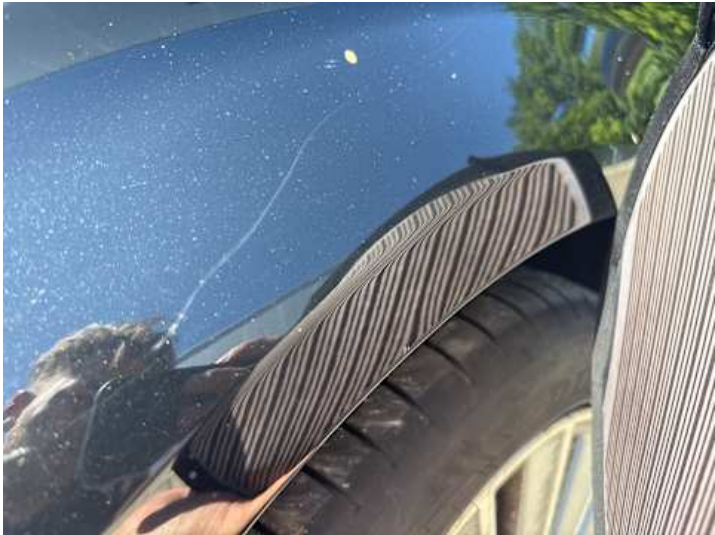
Kotflügel vorne links (Verformung)
