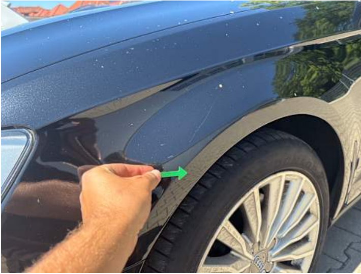
Kotflügel vorne links (Verformung)
