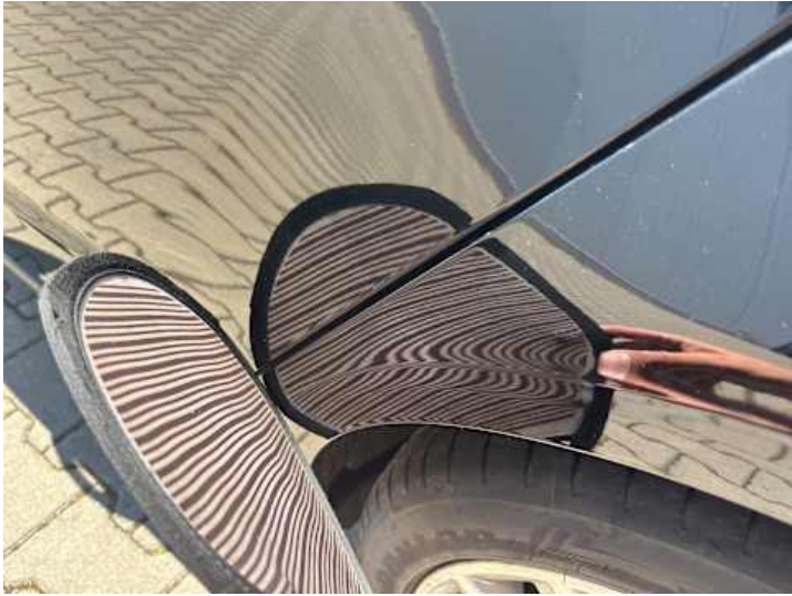
Seitenteil hinten links (Verformung)
