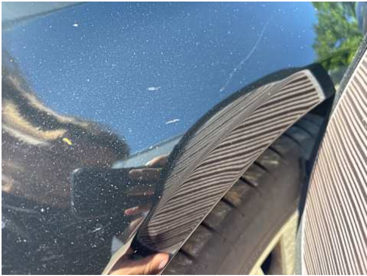
Kotflügel vorne links (Verformung)
