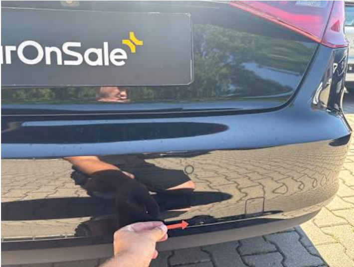
Stoßstange hinten (Lackschaden, Verformung)
