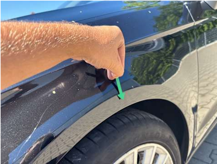
Kotflügel vorne links (Verformung)
