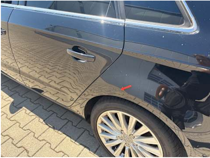
Seitenteil hinten links (Verformung)
