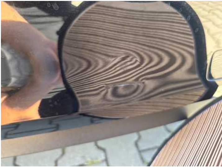
Stoßstange hinten (Lackschaden, Verformung)
