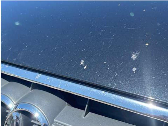
Motorhaube (Lackschaden, Steinschlag)
