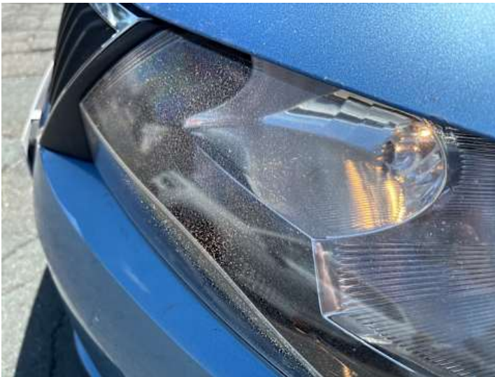
Scheinwerfer (links) (Anderer Schaden): Rissig/porös
