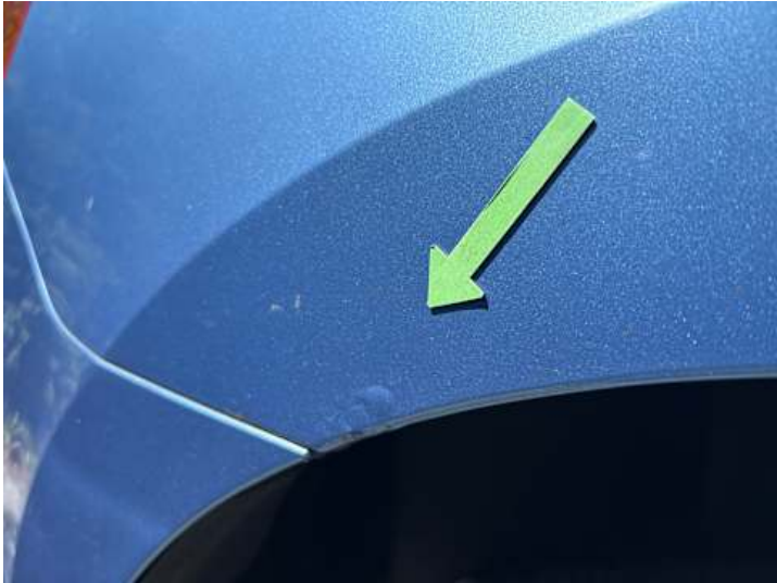
Seitenteil hinten rechts (Rost)
