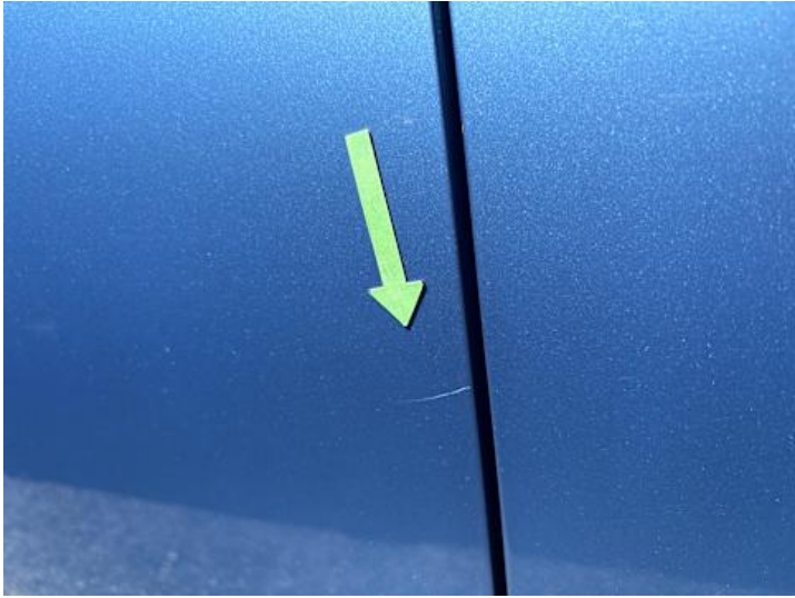
Türe hinten rechts (Kratzer)
