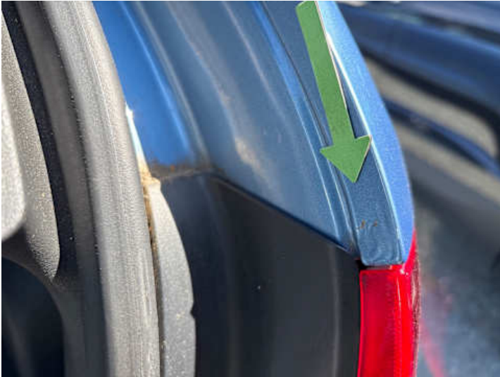
Seitenteil hinten rechts (Rost, Lackschaden)
