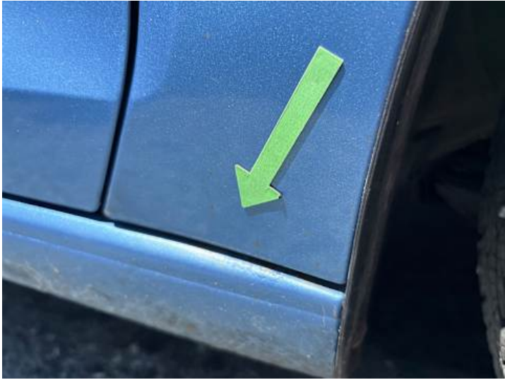
Kotflügel vorne rechts (Rost)
