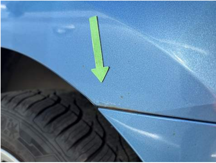
Seitenteil hinten links (Rost)
