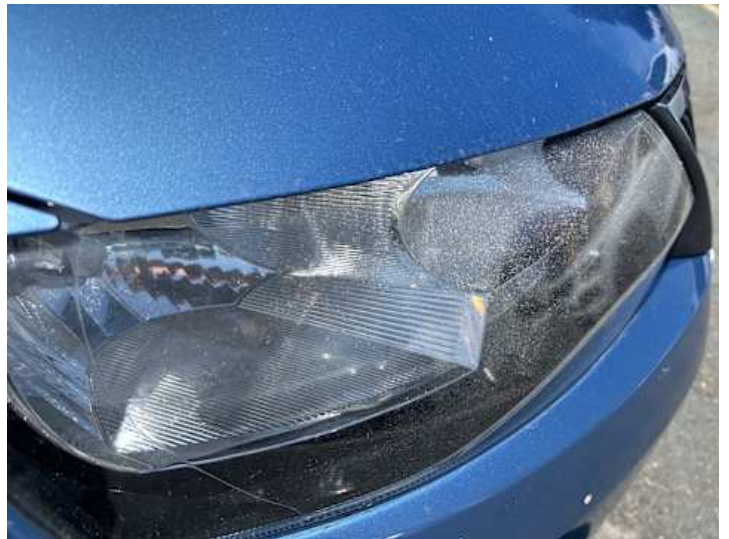
Scheinwerfer (rechts) (Anderer Schaden): Rissig/porös
