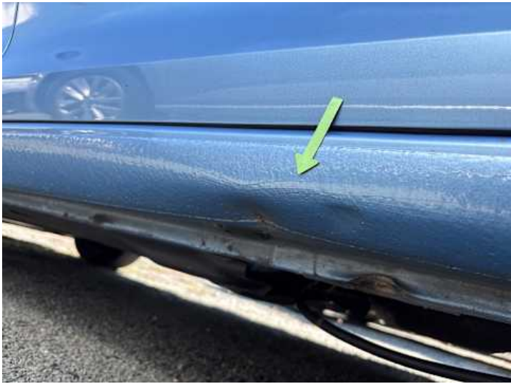
Schweller links (Lackschaden, Verformung)
