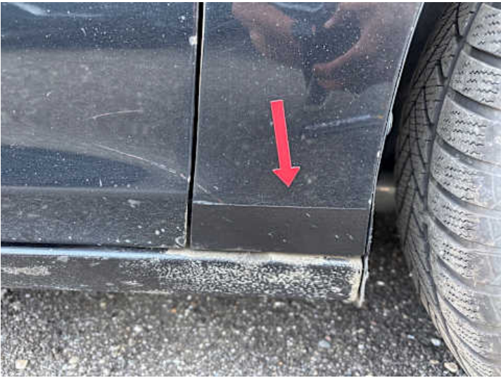
Kotflügel vorne rechts (Unsachgemäß instand gesetzt, Rost)
