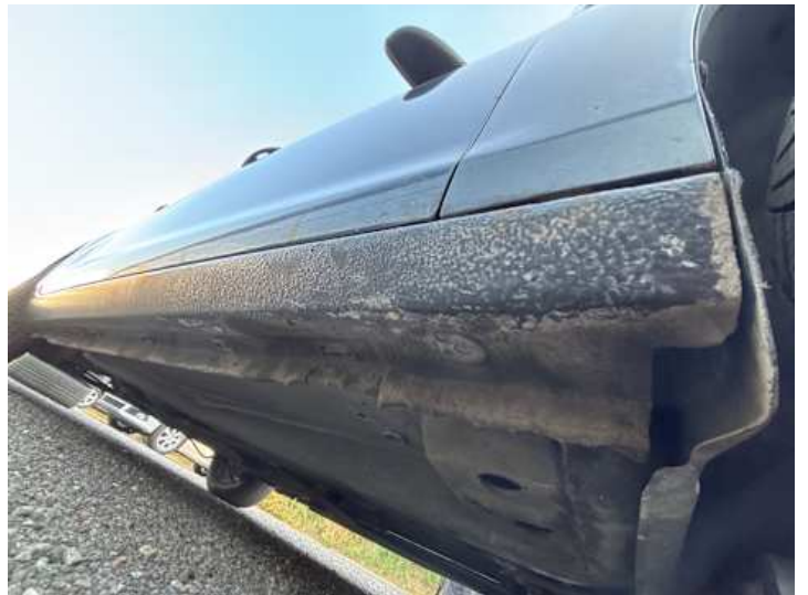
Schweller rechts (Rost)
