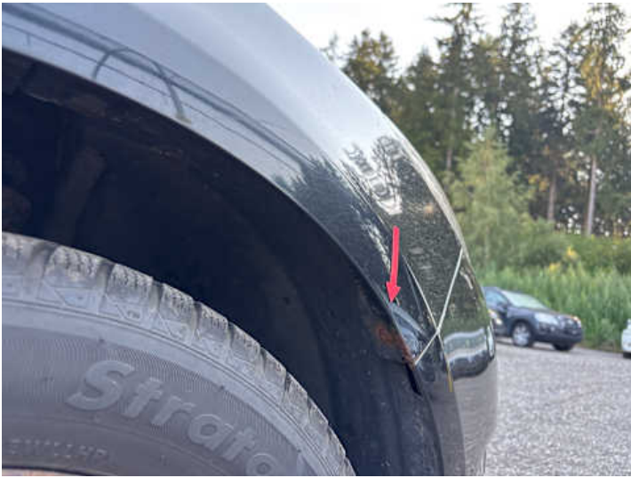
Kotflügel vorne rechts (Unsachgemäß instand gesetzt, Rost)
