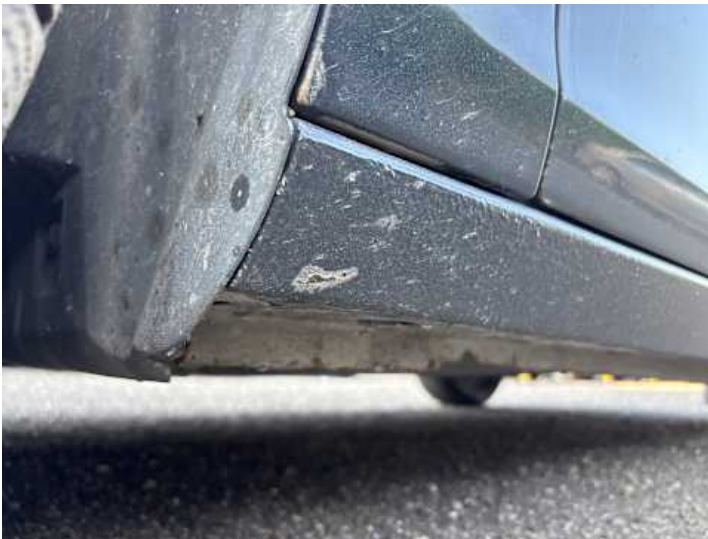
Schweller links (Lackschaden, Steinschlag, Rost)
