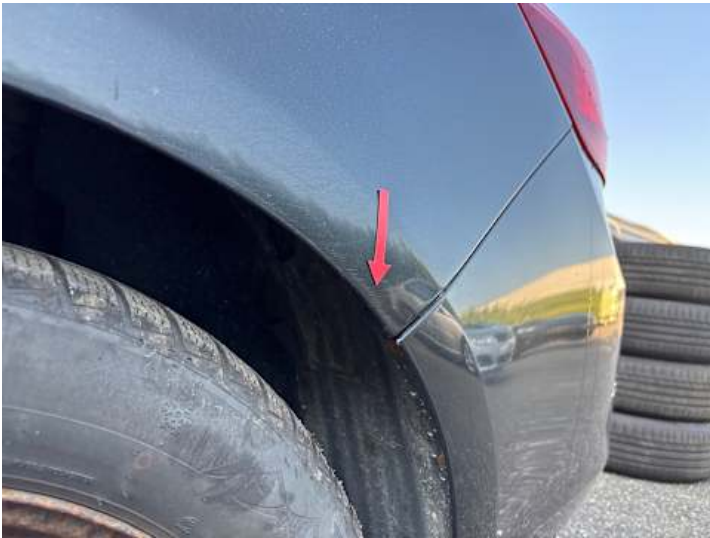
Seitenteil hinten links (Rost)
