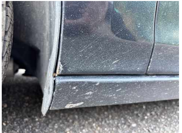
Kotflügel vorne links (Rost, Lackschaden)
