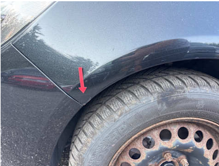
Kotflügel vorne links (Rost, Lackschaden)
