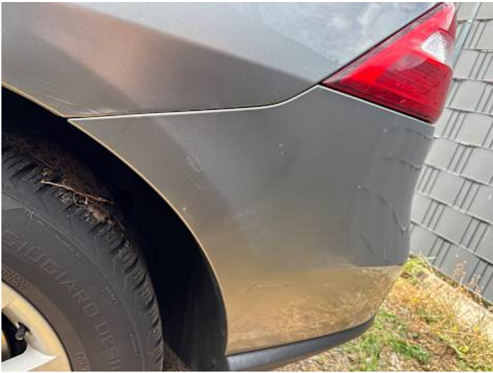
Stoßstange hinten (Lackschaden, Unsachgemäß instand gesetzt, Kratzer)
