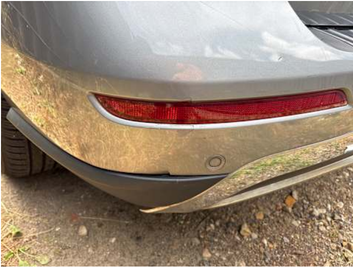
Stoßstange hinten (Riss/Bruch, Spaltmaße ungenau)
