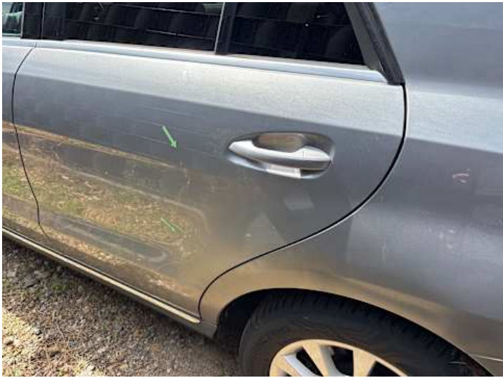
Türe hinten links (Lackschaden, Unsachgemäß instand gesetzt)
