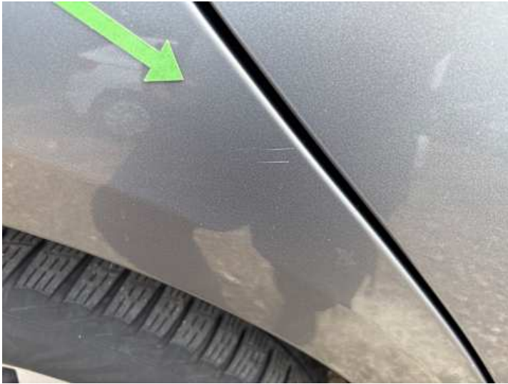
Seitenteil hinten rechts (Kratzer)
