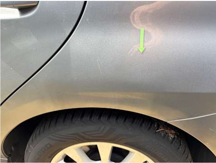
Seitenteil hinten links (Kratzer, Lackschaden, Delle, Unsachgemäß instand gesetzt)
