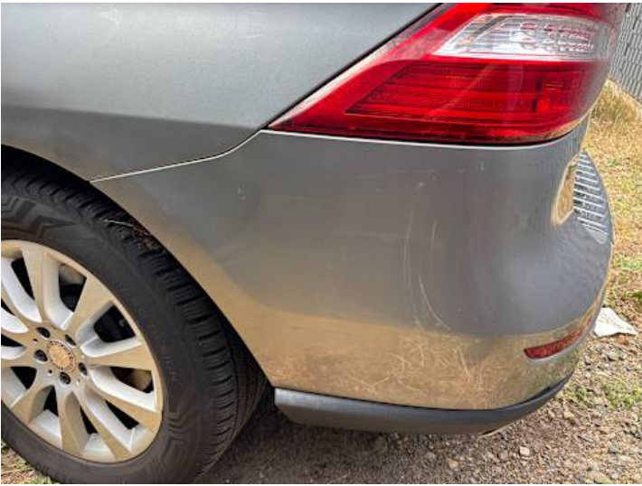
Stoßstange hinten (Lackschaden, Unsachgemäß instand gesetzt, Kratzer)
