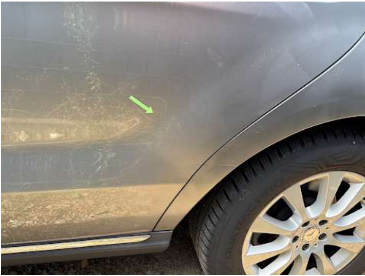
Türe hinten links (Lackschaden, Unsachgemäß instand gesetzt)
