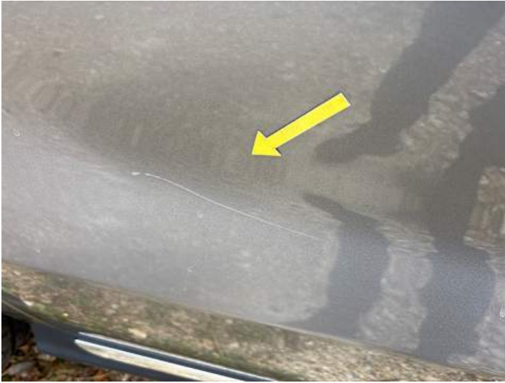
Türe hinten rechts (Kratzer)
