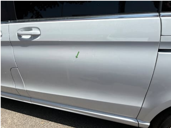
Türe hinten links (Delle)
