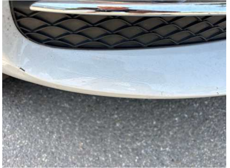
Stoßstange vorne (Delle, Kratzer)
