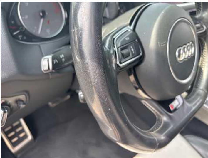
Innenraum (Verschmutzung, Verschleiß)
