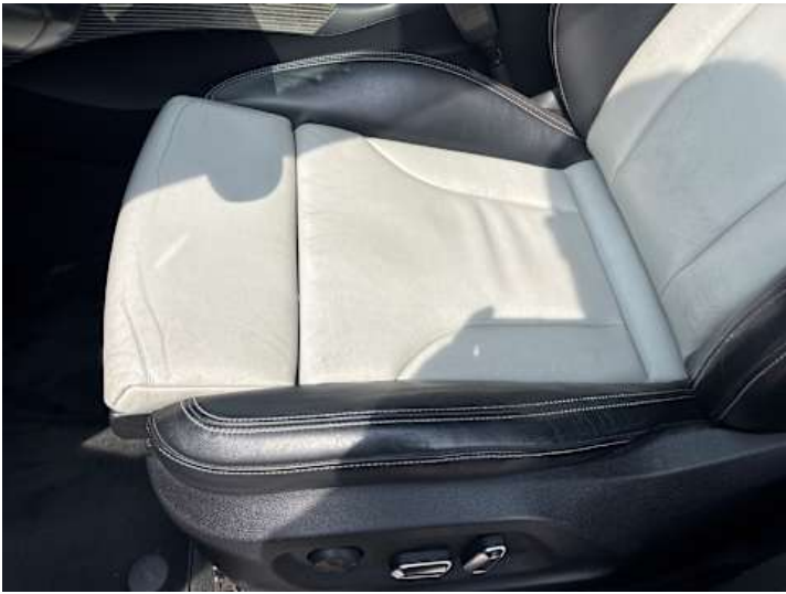
Innenraum (Verschmutzung, Verschleiß)
