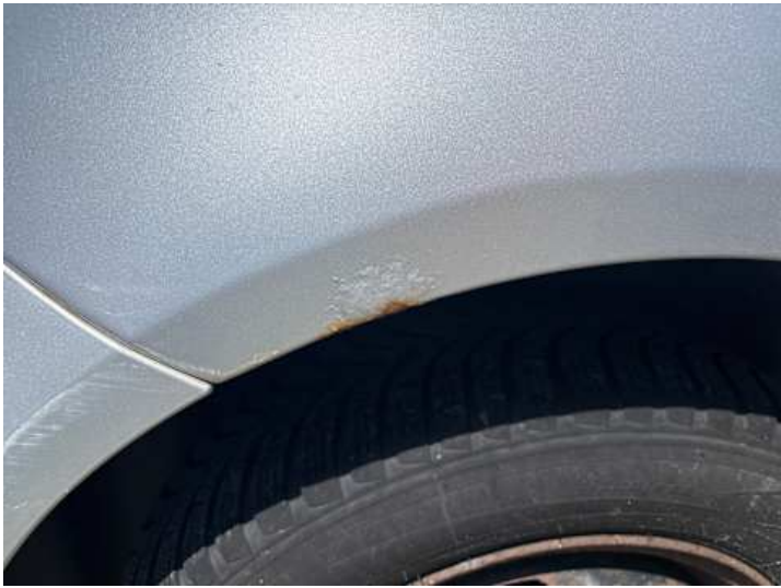
Seitenteil hinten rechts (Rost, Lackschaden)
