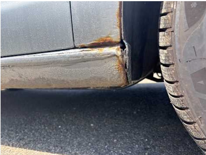
Schweller rechts (Rost, Lackschaden, Unsachgemäß instand gesetzt)
