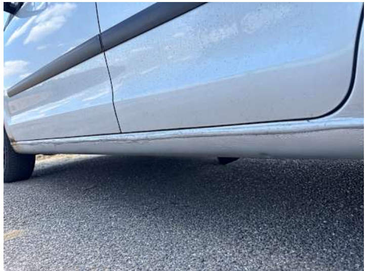
Schweller links (Lackschaden, Unsachgemäß instand gesetzt, Rost)
