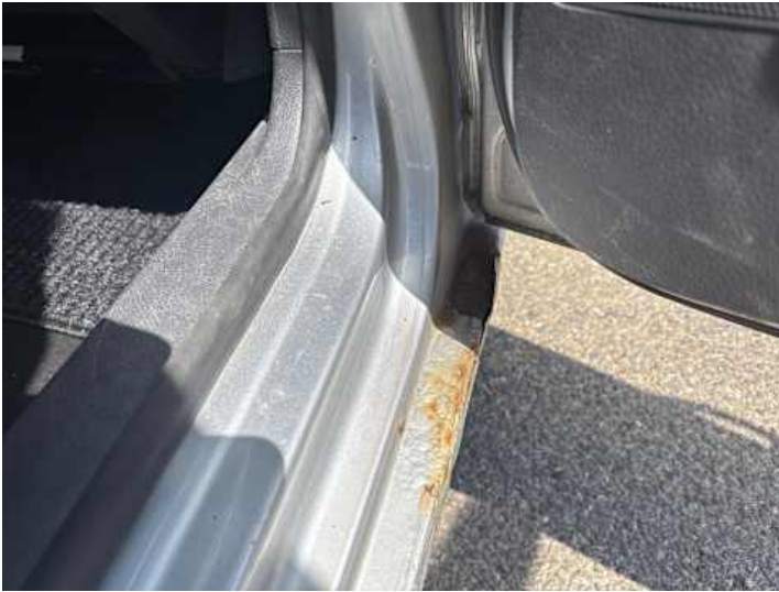
Schweller rechts (Rost, Lackschaden, Unsachgemäß instand gesetzt)
