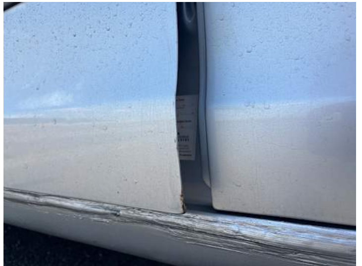
Fahrtür (Lackschaden, Rost)
