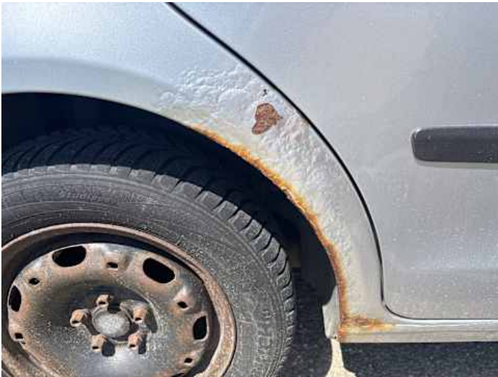
Seitenteil hinten rechts (Rost, Lackschaden)
