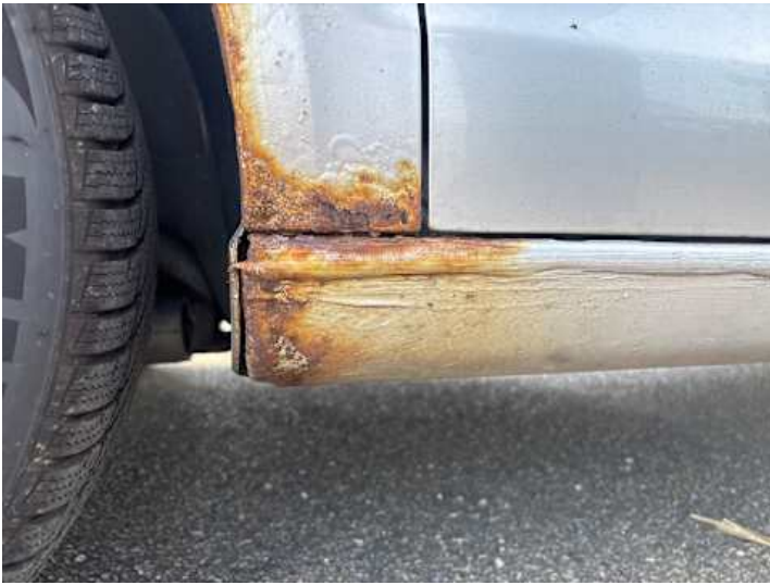
Schweller links (Lackschaden, Unsachgemäß instand gesetzt, Rost)
