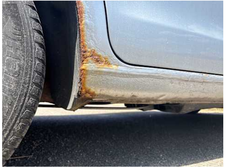
Schweller rechts (Rost, Lackschaden, Unsachgemäß instand gesetzt)
