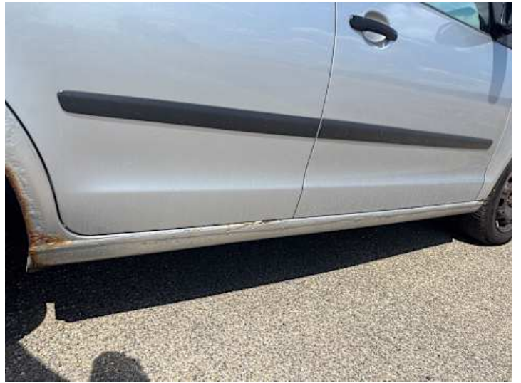
Schweller rechts (Rost, Lackschaden, Unsachgemäß instand gesetzt)
