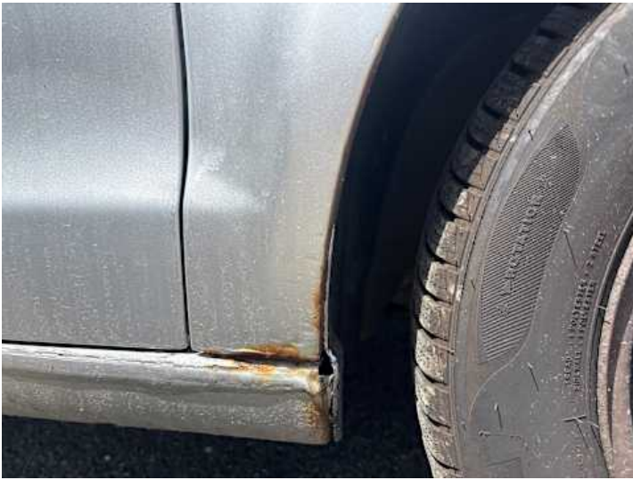
Kotflügel vorne rechts (Rost, Lackschaden)
