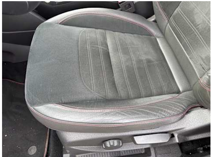
Innenraum (Verschmutzung, Verschleiß)
