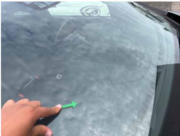
Windschutzscheibe (Riss/Bruch, Steinschlag)
