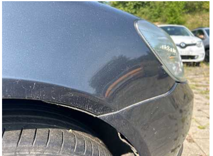
Kotflügel vorne rechts (Verformung, Spaltmaße ungenau)
