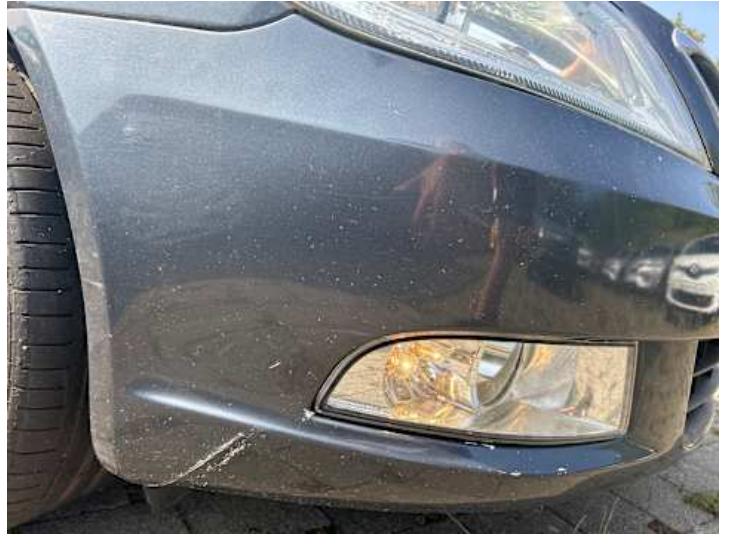
Stoßstange vorne (Kratzer, Lackschaden, Spaltmaße ungenau)
