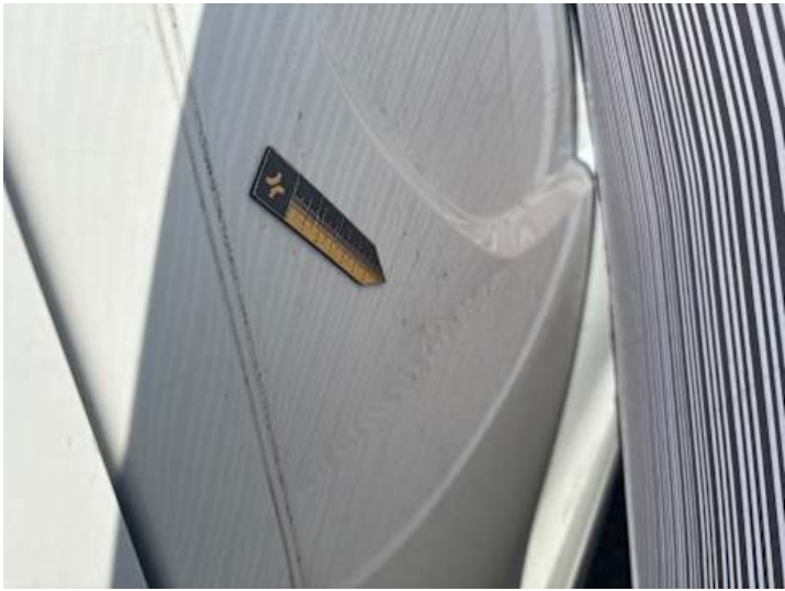
Seitenteil hinten links (Delle, Verformung)
