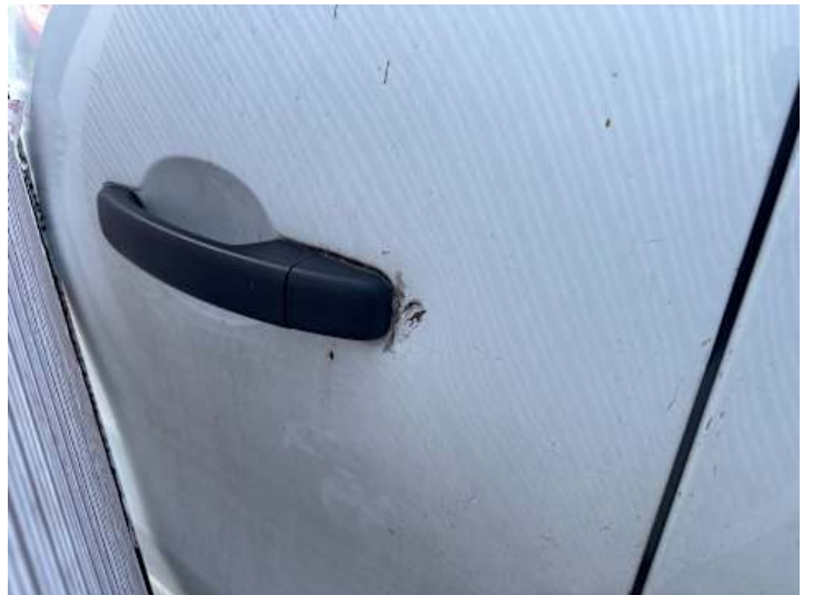
Türe hinten rechts (Delle, Verformung)
