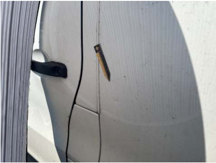
Seitenteil hinten links (Delle, Verformung)
