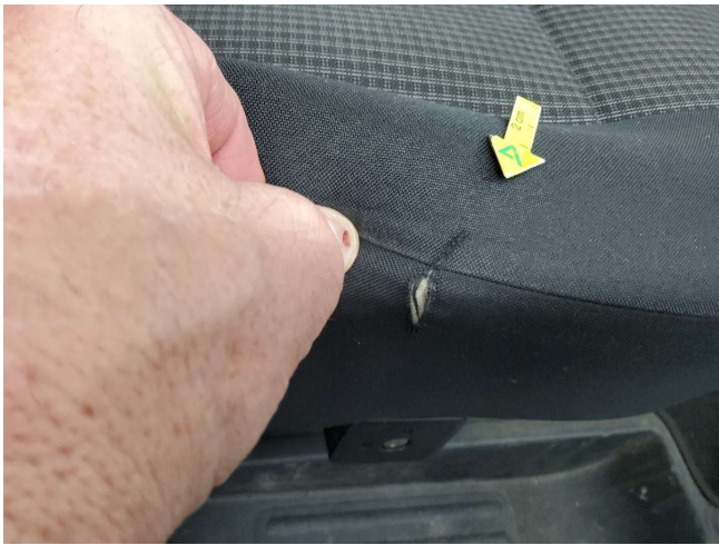
Beifahrersitzbezug Sitzfläche beschädigt (DEKRA)
