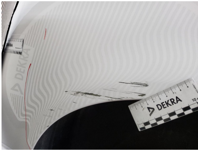
Seitenwand (lang) hinten links, hinten, deformiert, instandsetzen und lackieren mit Lackaufbau (DEK..
