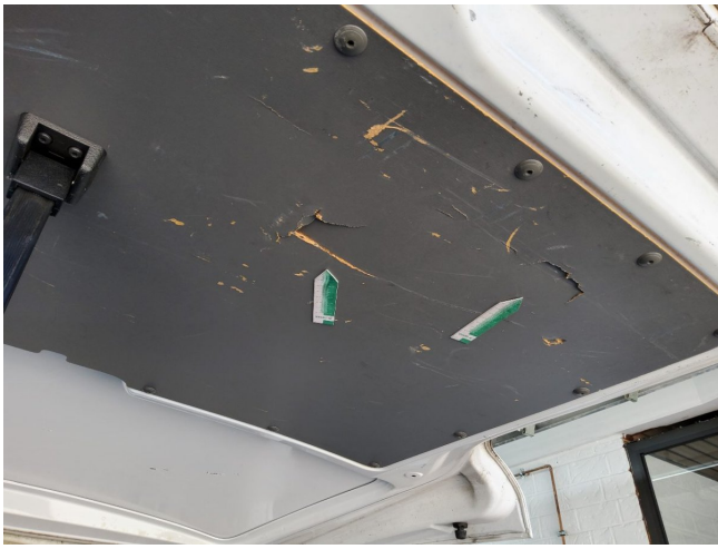
Heckklappenverkleidung beschädigt (DEKRA)
