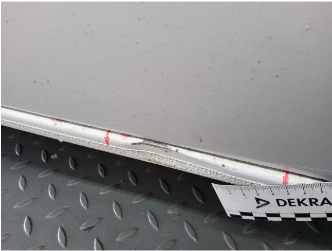
Unterholm rechts mehrfach eingedrückt (DEKRA)
