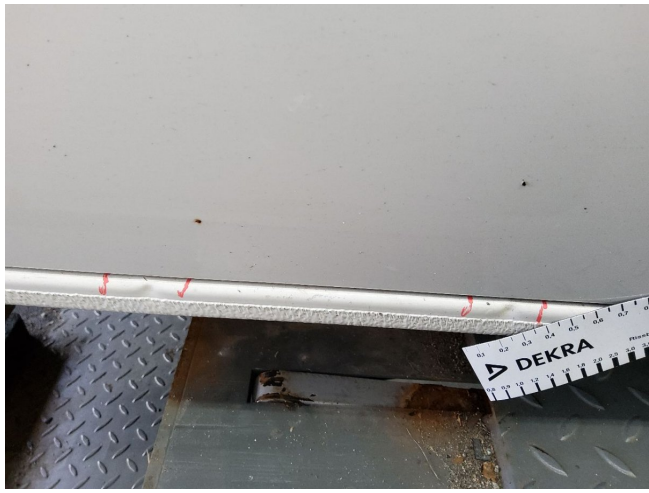
Unterholm rechts mehrfach eingedrückt (DEKRA)
