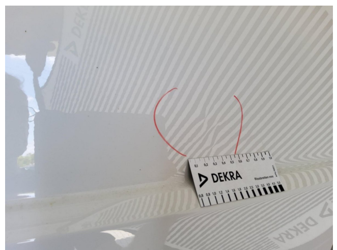
Heckklappe, deformiert, instandsetzen und lackieren mit Lackaufbau (DEKRA)
