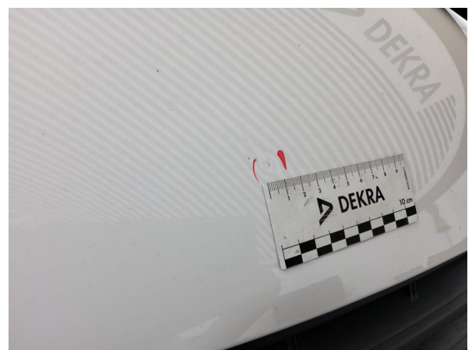
Motorhaube Lackierung, Steinschlag, Gebrauchsspur (DEKRA)
