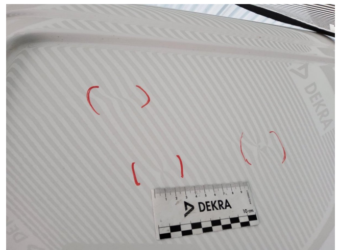
Seitenwand (lang) hinten rechts, hinten, mehrfach eingedellt, drücken (DEKRA)
