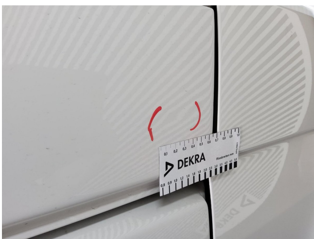
Seitenwand (lang) hinten rechts, hinten, mehrfach eingedellt, drücken (DEKRA)
