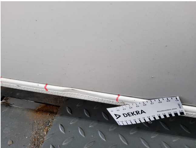
Unterholm rechts mehrfach eingedrückt (DEKRA)
