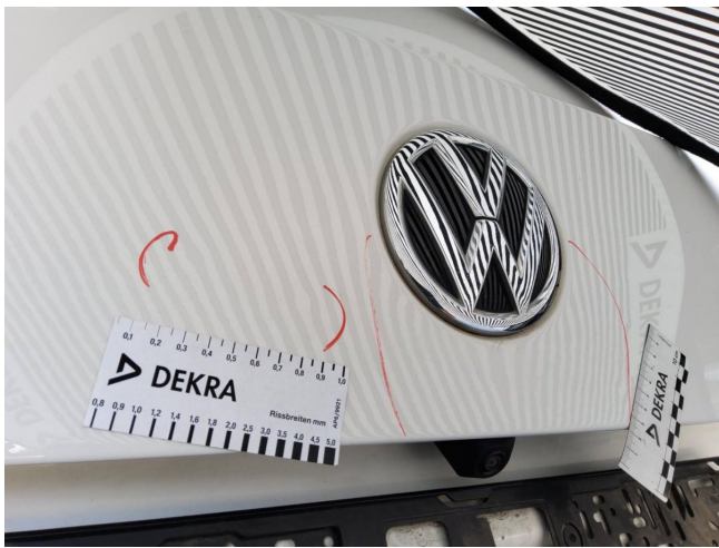
Heckklappe, deformiert, instandsetzen und lackieren mit Lackaufbau (DEKRA)
