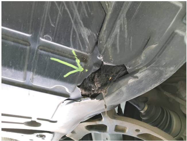
Motorabdeckung unten beschädigt (DEKRA)
