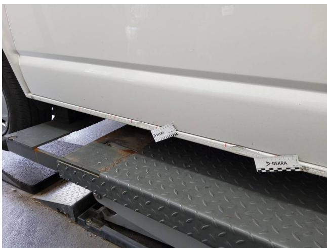
Unterholm rechts mehrfach eingedrückt (DEKRA)
