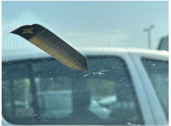
Windschutzscheibe (Steinschlag, Riss/Bruch)
