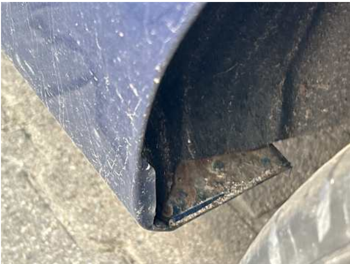
Schweller links (Rost)
