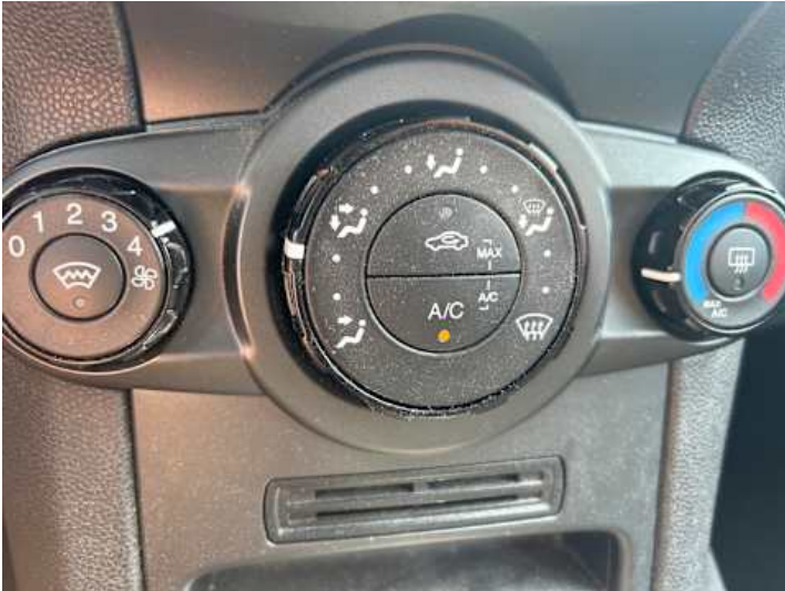
Innenraum (Anderer Schaden): Mittlerer Drehregler endanschlag defekt
