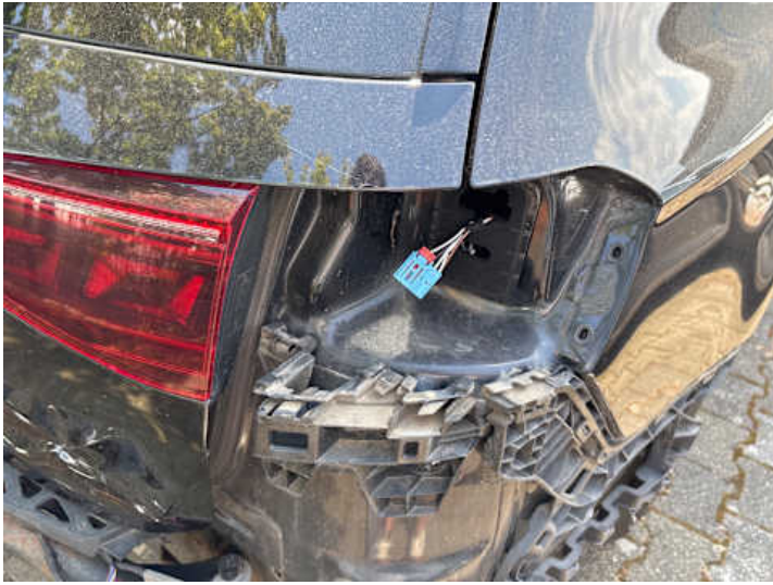
Rücklicht (rechts) (Riss/Bruch)
