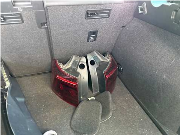
Rücklicht (rechts) (Riss/Bruch)
