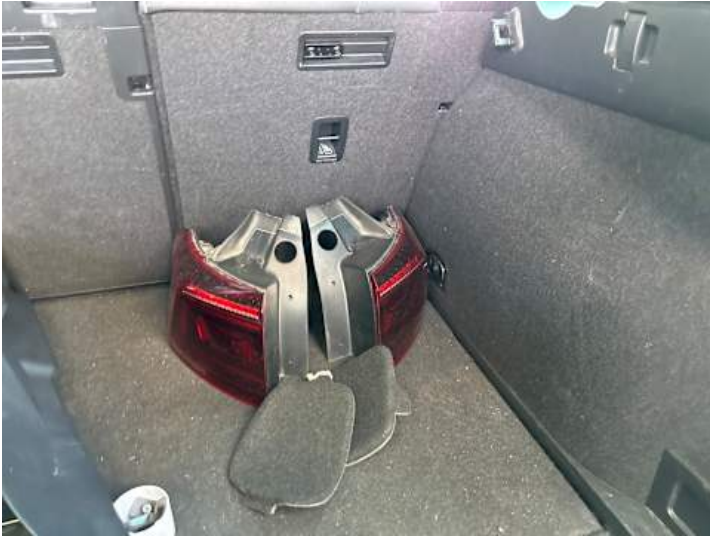
Rücklicht (links) (Riss/Bruch)
