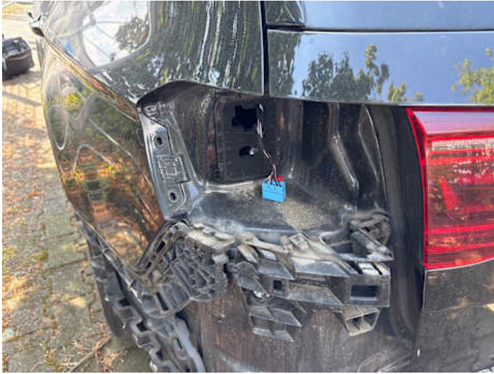
Rücklicht (links) (Riss/Bruch)
