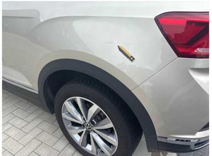
Seitenteil hinten links (Kratzer)
