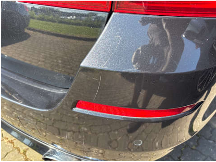
Stoßstange hinten (Kratzer, Riss/Bruch)
