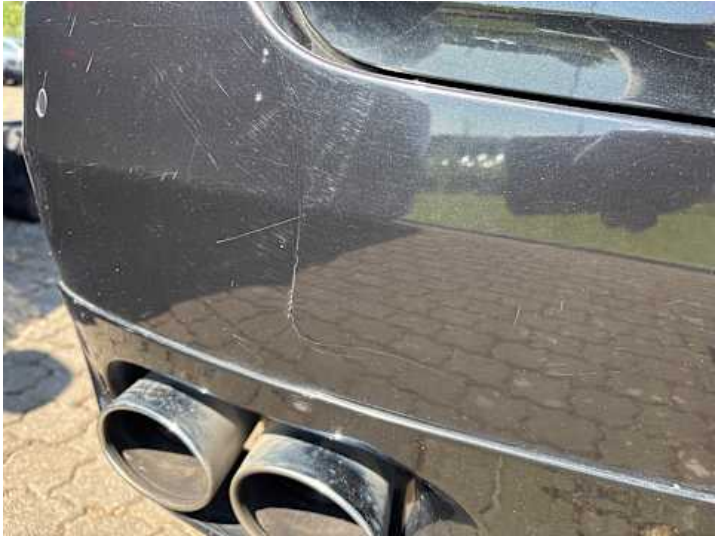
Stoßstange hinten (Kratzer, Riss/Bruch)
