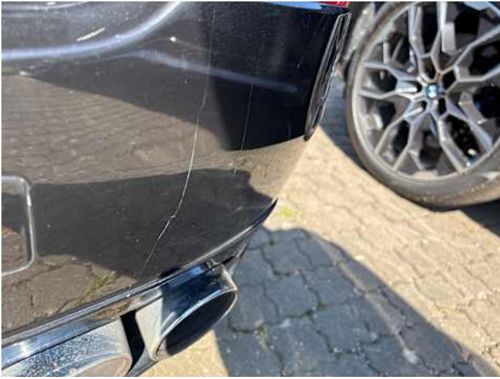
Stoßstange hinten (Kratzer, Riss/Bruch)
