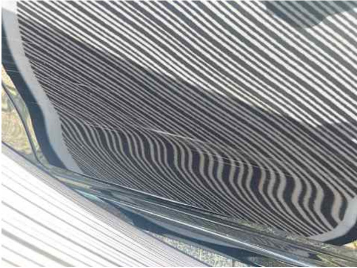
Türe hinten links (Verformung)
